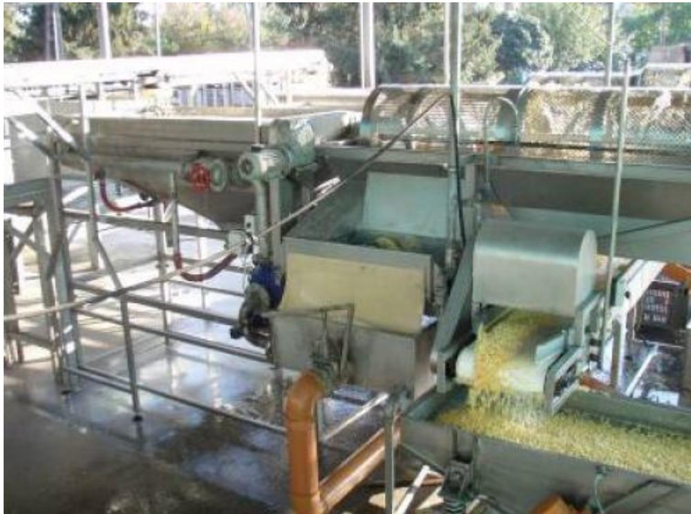
**Вибрационная моечная машина А9-КМ2Ц позволяет производить мойку мелкоплодных фруктов, бобовых культур, ягод и ополаскивать мелкоплодные овощи, а также для охлаждения их после тепловой обработки. Она состоит из каркаса 1, душевого устройства 3, сита 2 и привода 5.**
