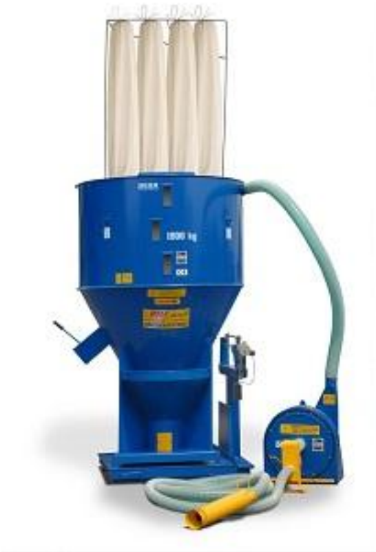
Рис. Дробилка зерна ДПЗ-1 (1 т/ч)
