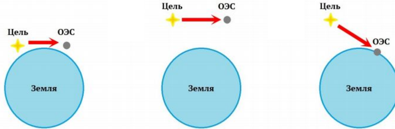
Виды траекторий, проходимых сигналом от цели до оптико-электронной системы
