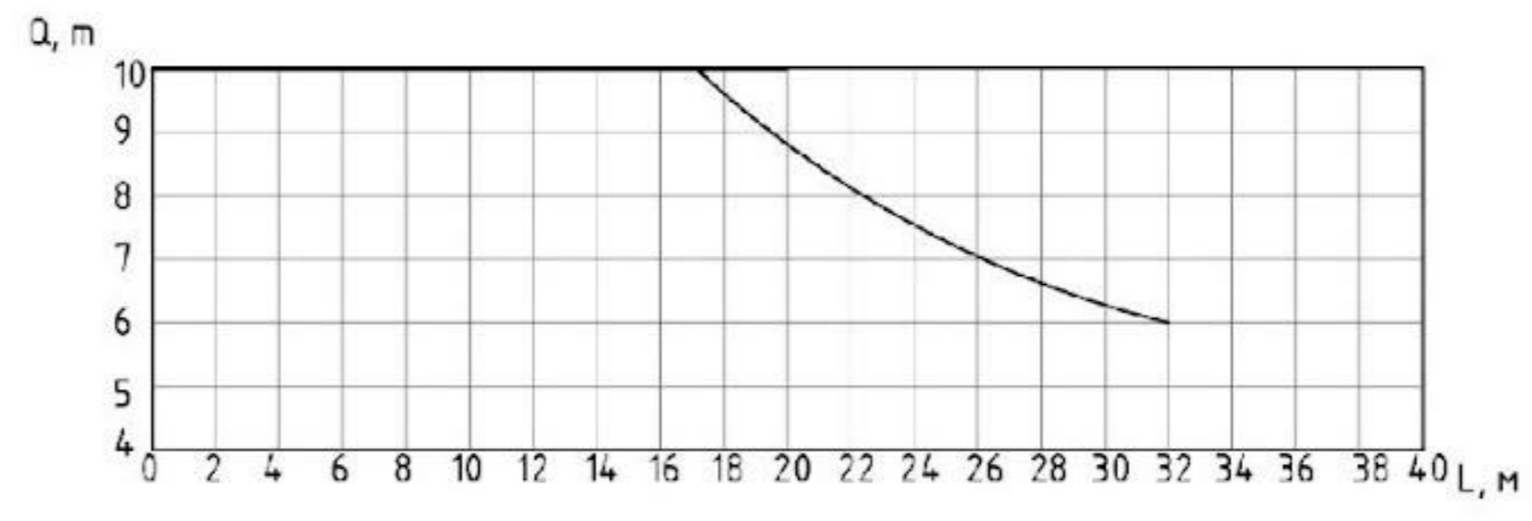
Диаграмма грузовой характеристик крана КБк-250
