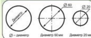
Ø – диаметр      Диаметр 60 мм      Диаметр 20 мм
