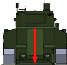
ПЕРЕМЕЩЕНИЕ ПЕРЕДНЕГО ОБТЕКАТЕЛЯ ХОДОВОЙ ЧАСТИ И ФИКСИРОВАНИЕ В РАБОЧЕМ ПОЛОЖЕНИИ КОРМОВОГО КРЫЛА
