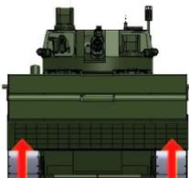
ВТЯГИВАНИЕ ХОДОВОЙ ЧАСТИ НА ПЛАВУ
