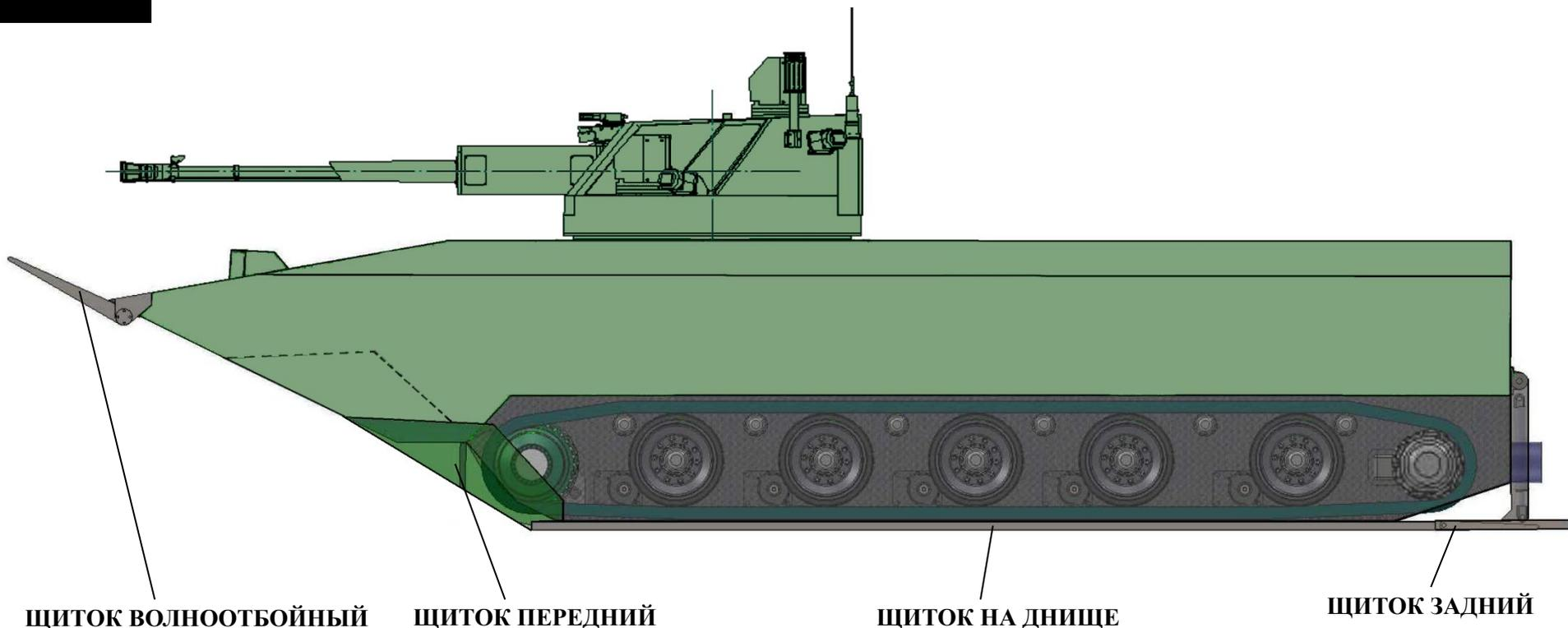
Механизм изменения обвода корпуса предназначен для улучшения гидродинамических характеристик машины при переходе из водоизмещающего режима плавания в режим глиссирующий и представляет совокупность механизмов, состоящих из гидроуправляемых механиком-водителем волноотбойного щитка, переднего щитка, двух щитков на днище корпуса и заднего щитка с механизмом изменения ходового дифферента.
