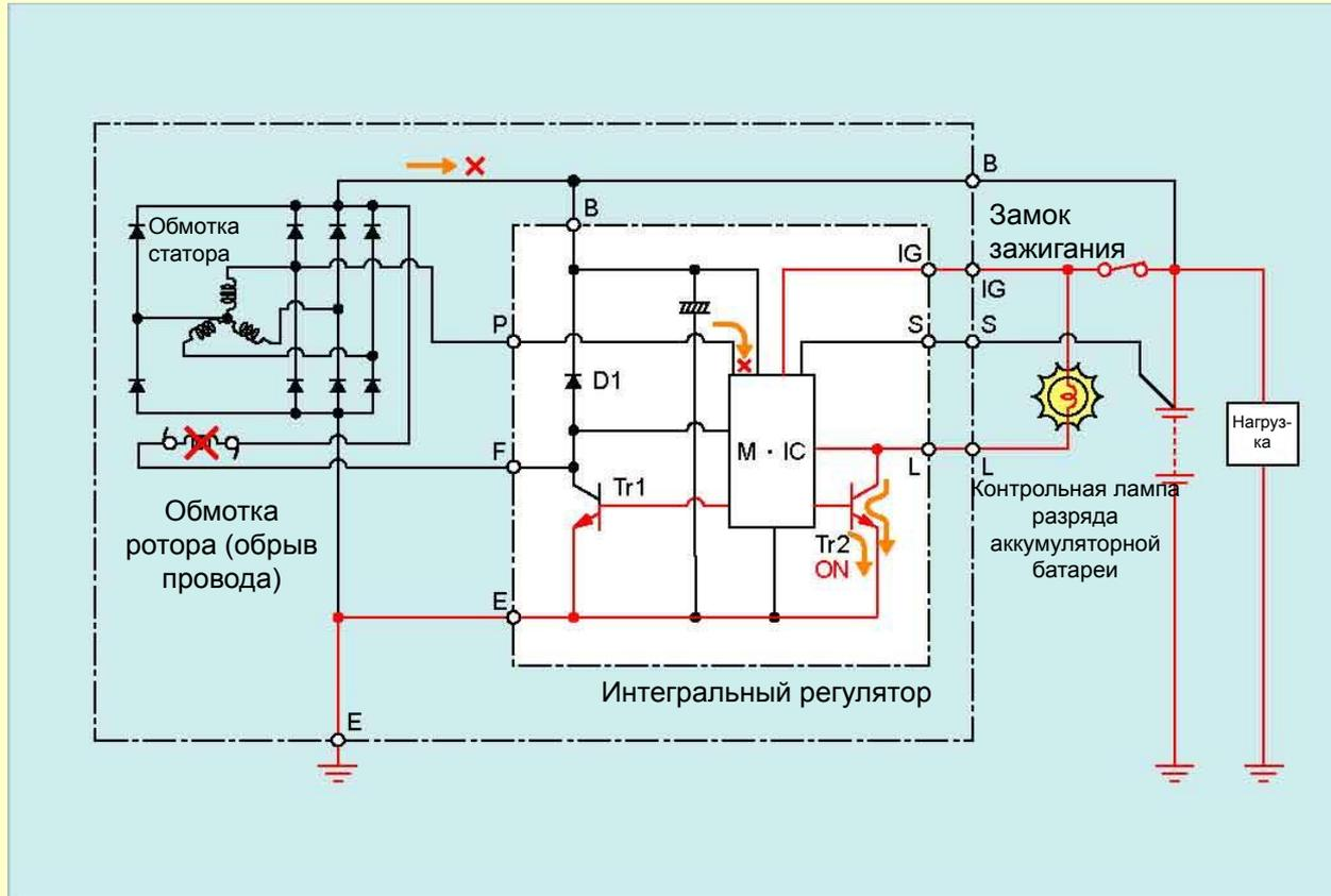
(3) Обрыв провода опорного напряжения ("нет напряжения на контакте S")
