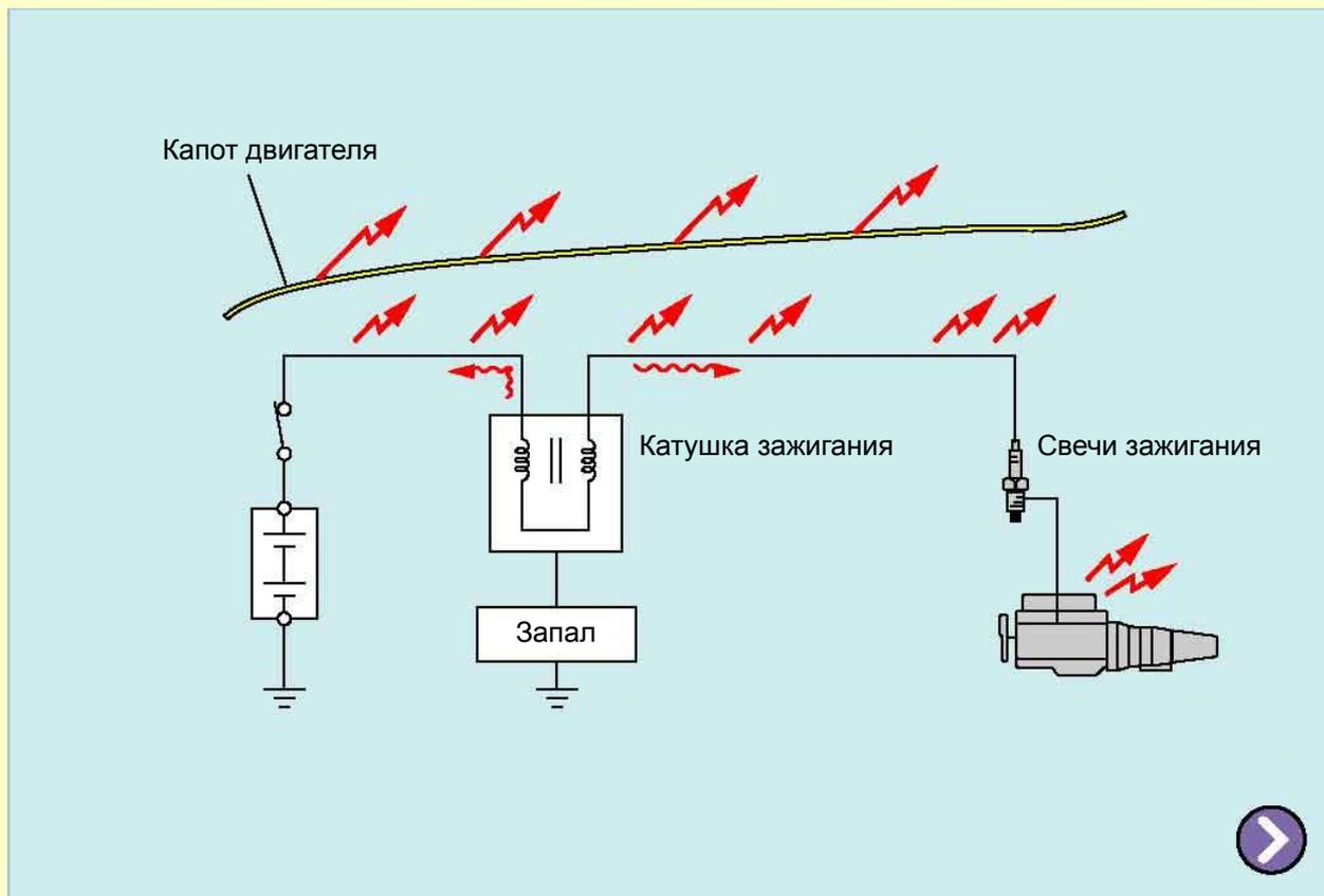
Помехи радиоприёму >> (3) Снижение помех радиоприёму <1> Система зажигания
