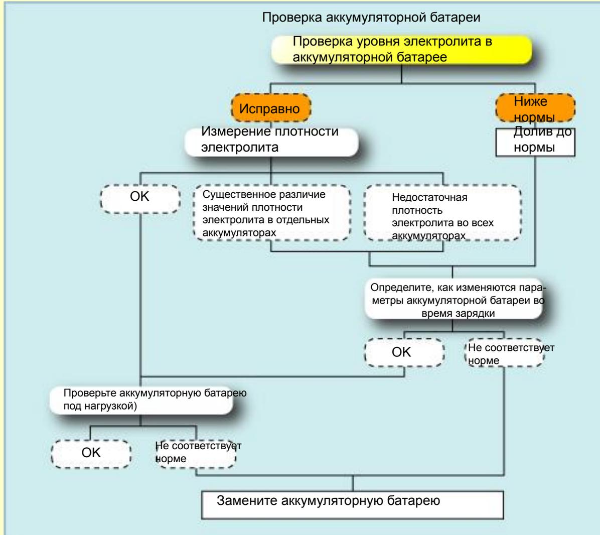
**1. Проверка уровня электролита в аккумуляторной батарее**
