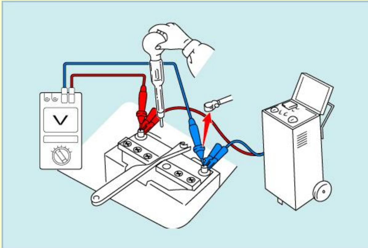
4. Проверка аккумуляторной батареи под нагрузкой
