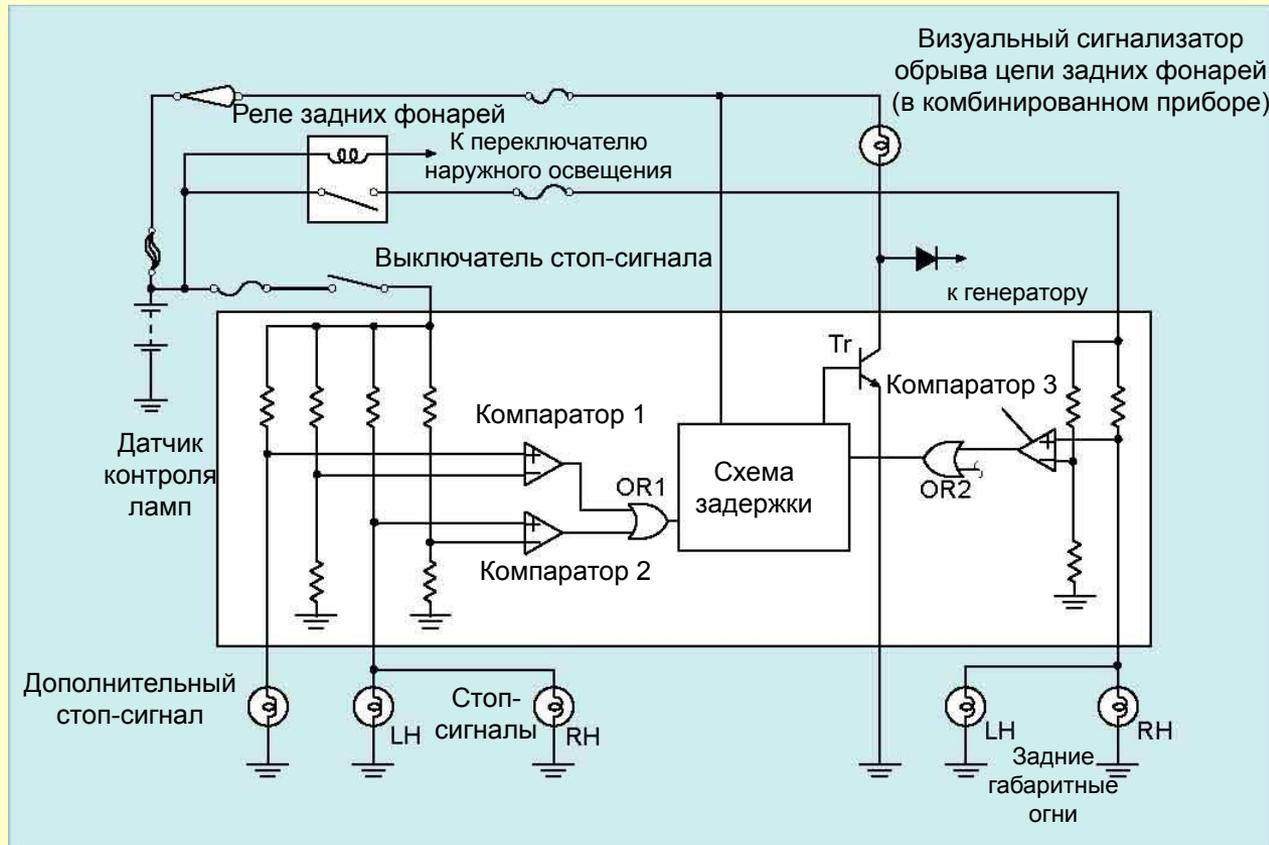
Система контроля ламп задних световых приборов
