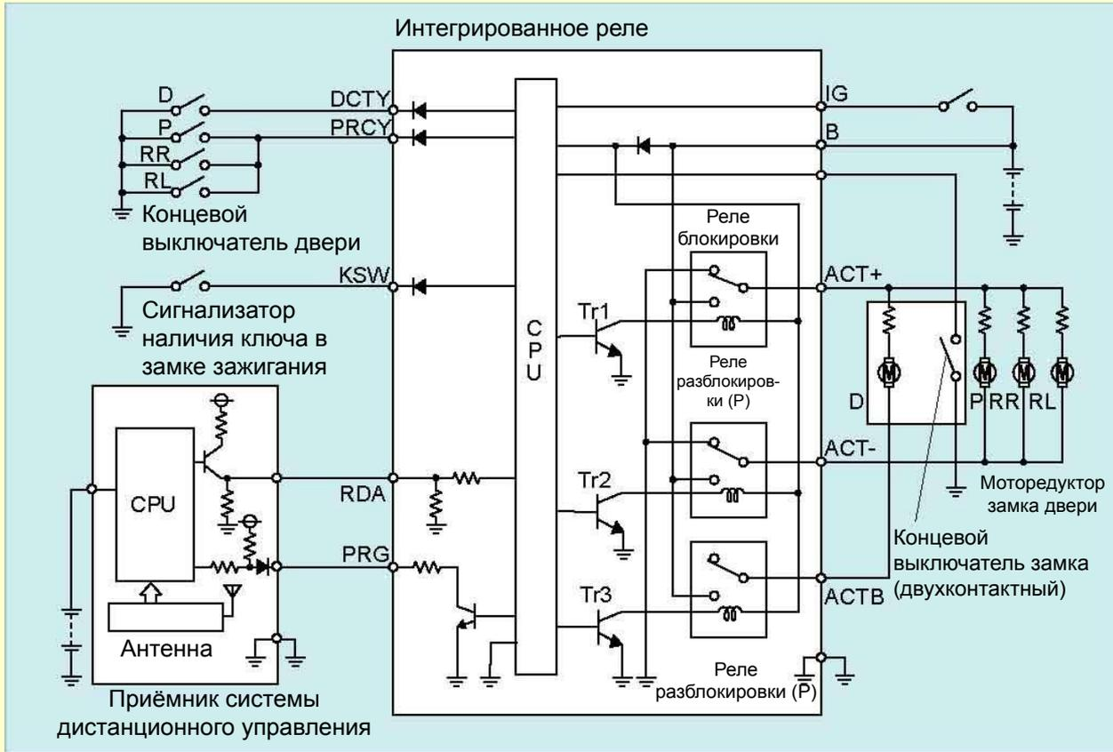
**Система дистанционной блокировки замков дверей**
