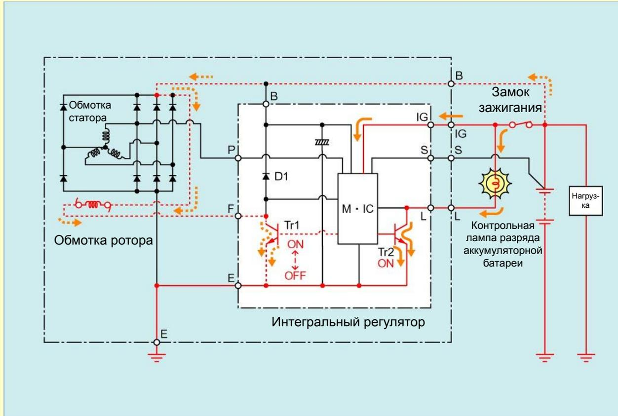
2. Нарушение работы генераторной установки (1) Обрыв обмотки возбуждения
