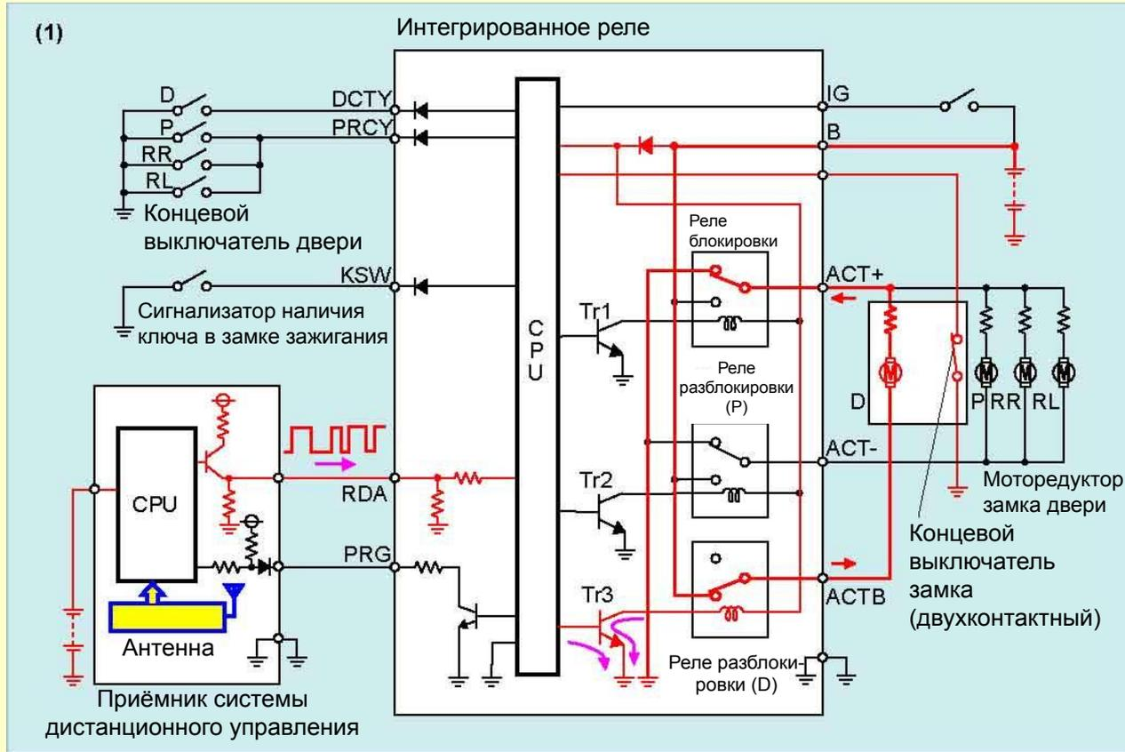
**Система дистанционной блокировки замков дверей**
