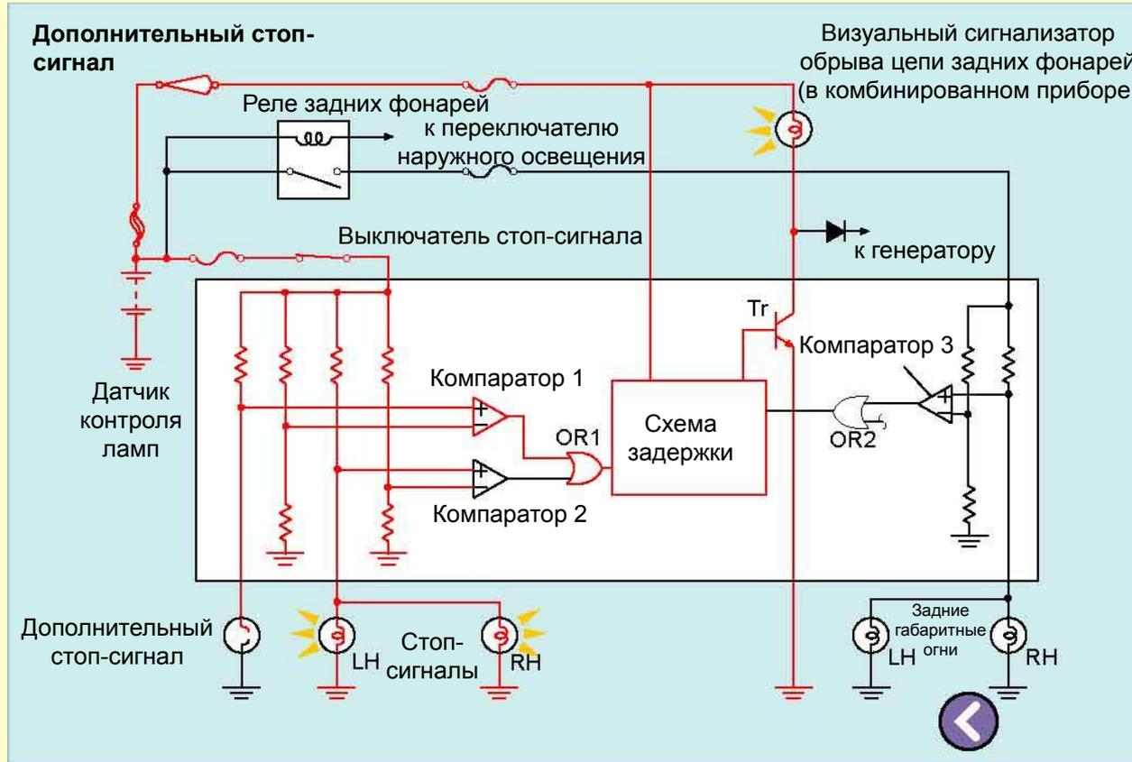
Система контроля ламп задних световых приборов
