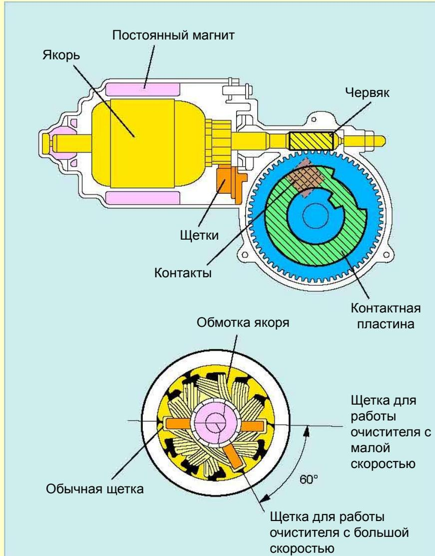
(3) Пластинчатый концевой выключатель
