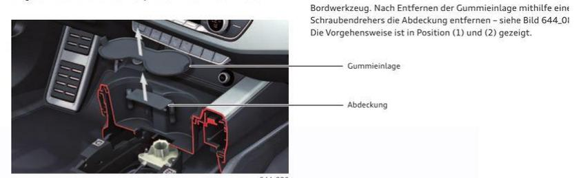
Bordwerkzeug. Nach Entfernen der Gummieinlage mithilfe ein Schraubendrehers die Abdeckung entfernen – siehe Bild 644\_01 Die Vorgehensweise ist in Position (1) und (2) gezeigt.
