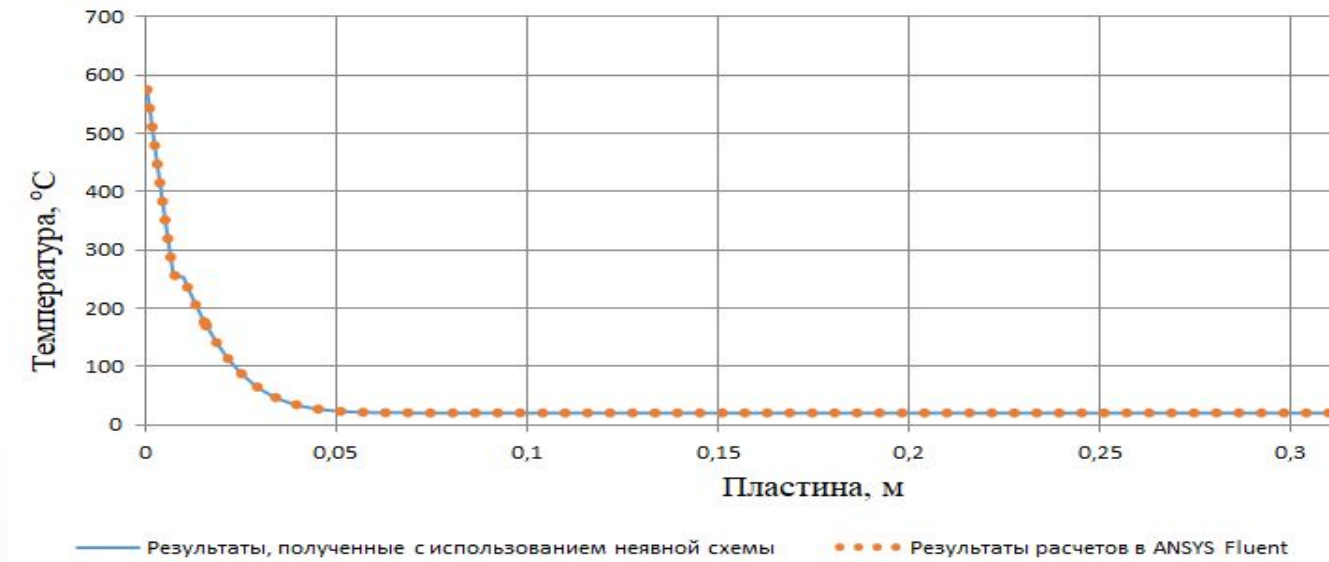
Рисунок 10 - Графики сравнения температур через 600 секунд
