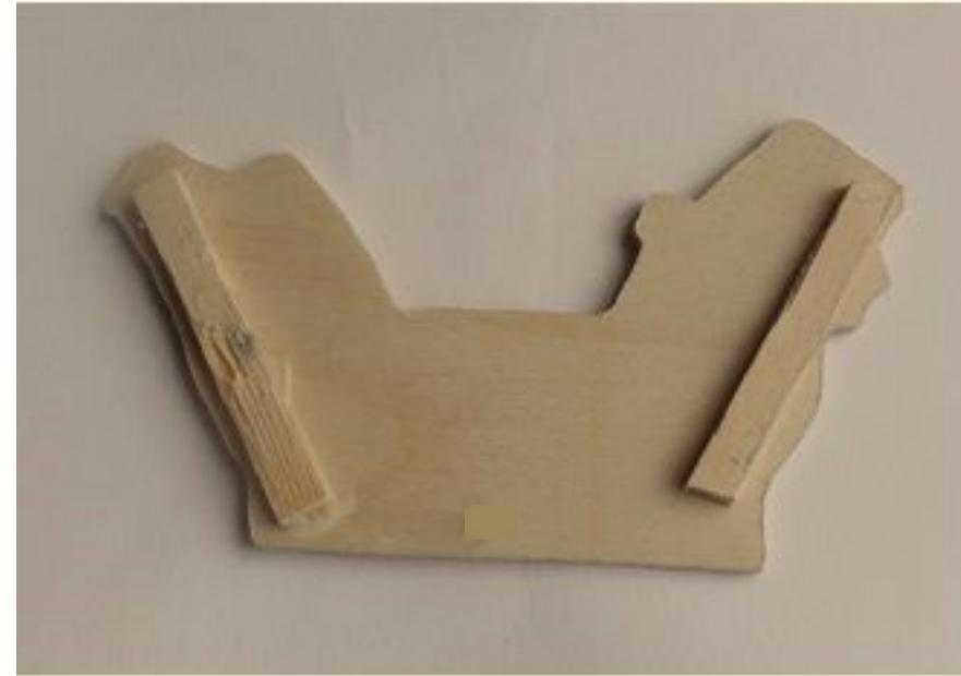
4. Приклеить деревянные полоски к боковым сторонам детали. Толщина полосок должна быть чуть больше 3 мм.
