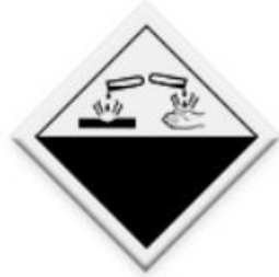
Коррозионные и едкие вещества
