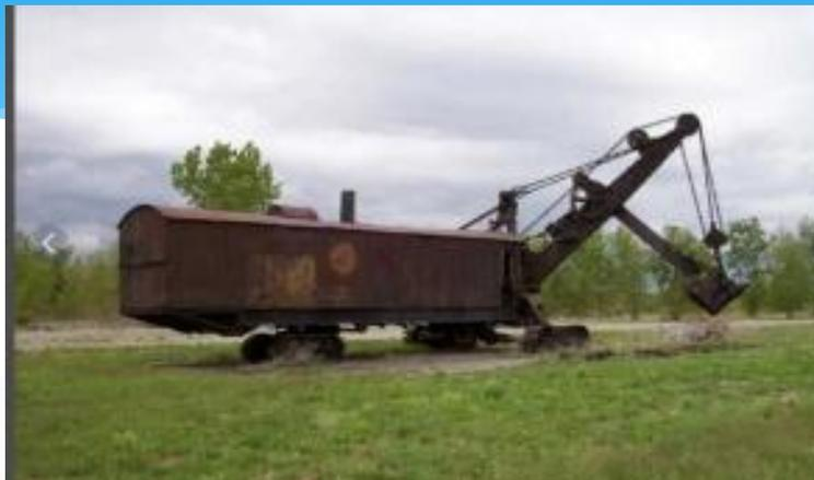
Первый экскаватор на паровой тяге и канатном приводе
