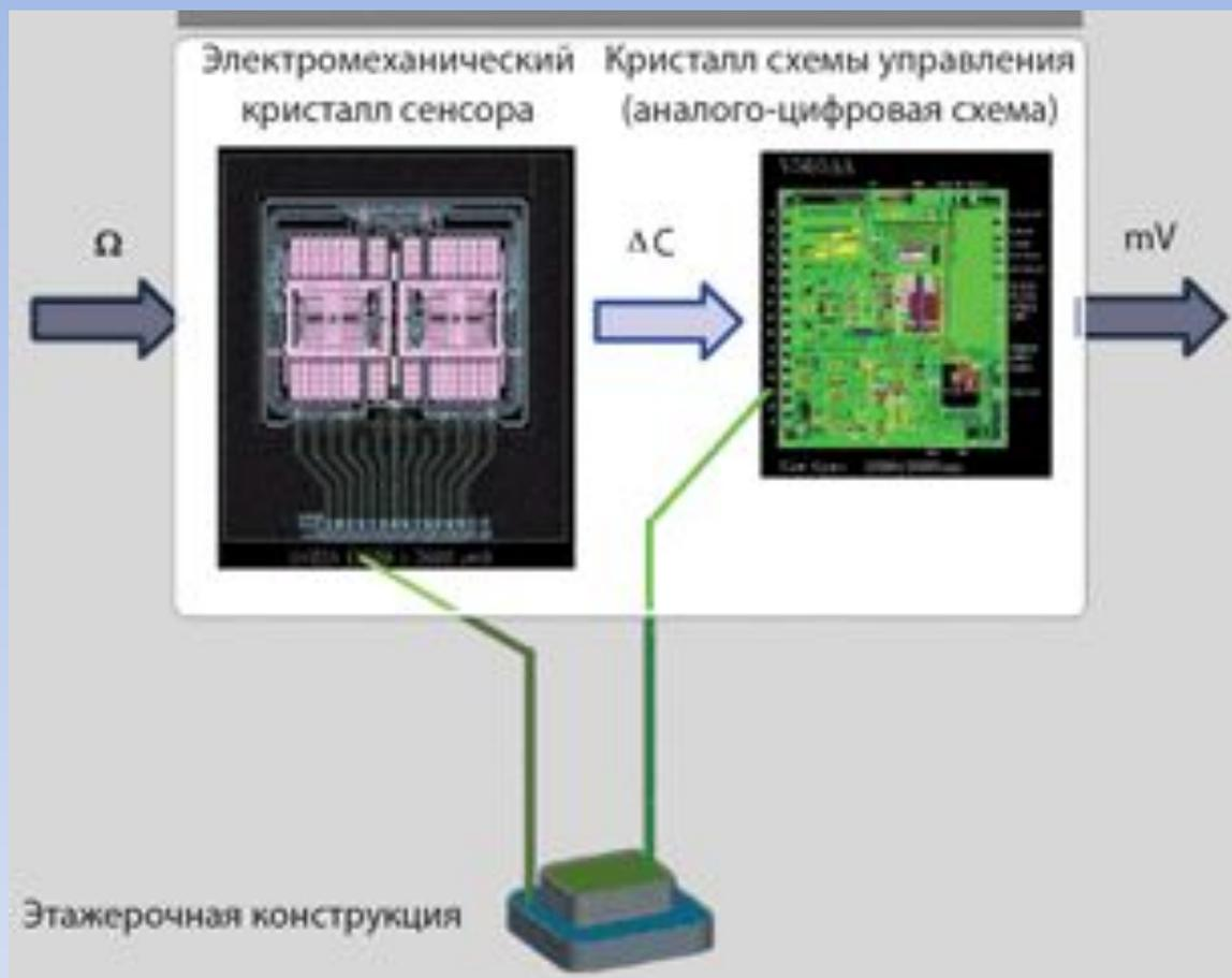
Использование вертикальной конструкции для стыковки двух кристаллов
