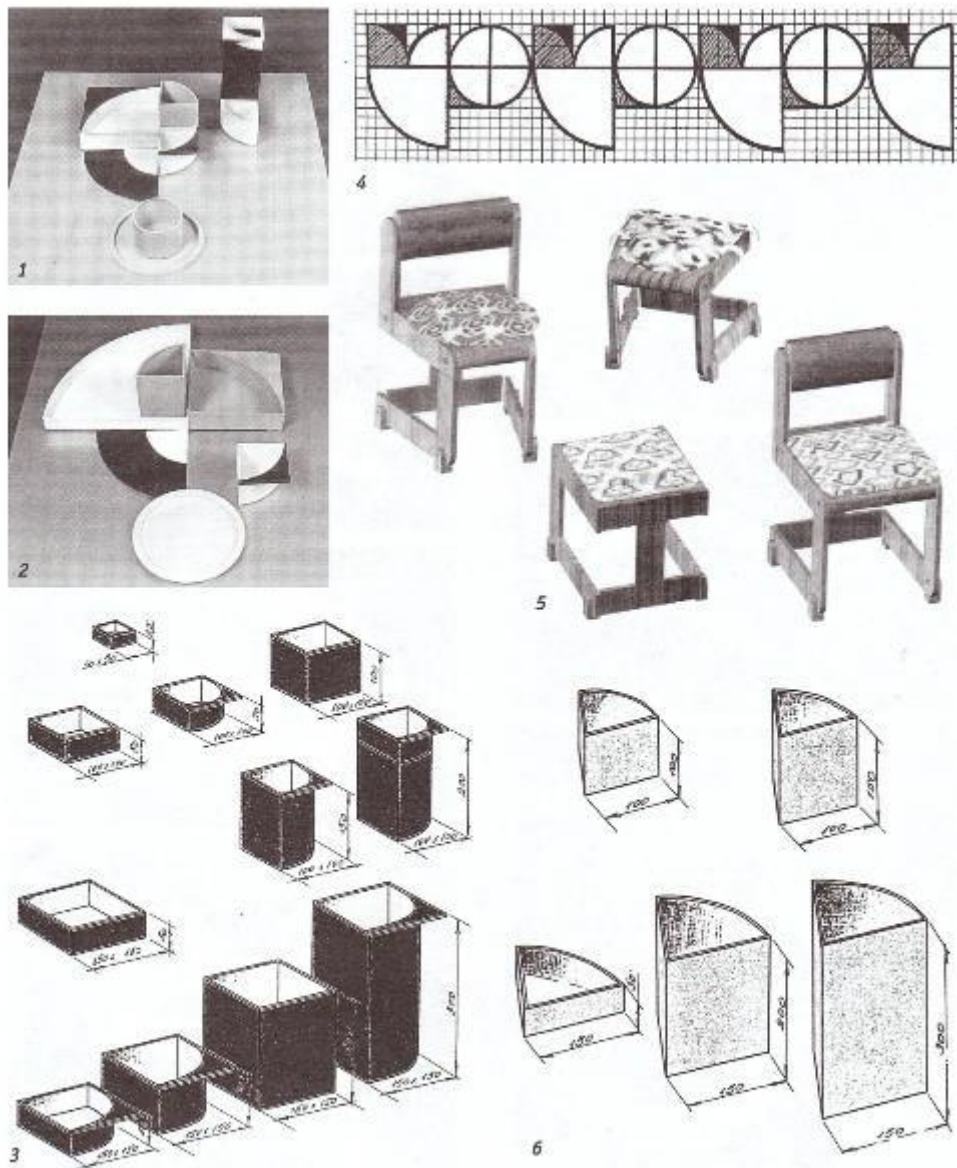
Рис. 37. Принципиальные решения формы столовой посуды и мебели для сидения: 1,2 — типовые индивидуальные наборы столовой посуды из модульных элементов. Варианты криволинейной; 3,6 — параметрические размерно-поворотные ряды некоторых элементов столовой посуды; 4 — вариант декоративного узора (для посуды и столового белья), составленного из геометрических фигур — модульных элементов посуды; 5 — прямые и трапециевидные табуреты и стулья
