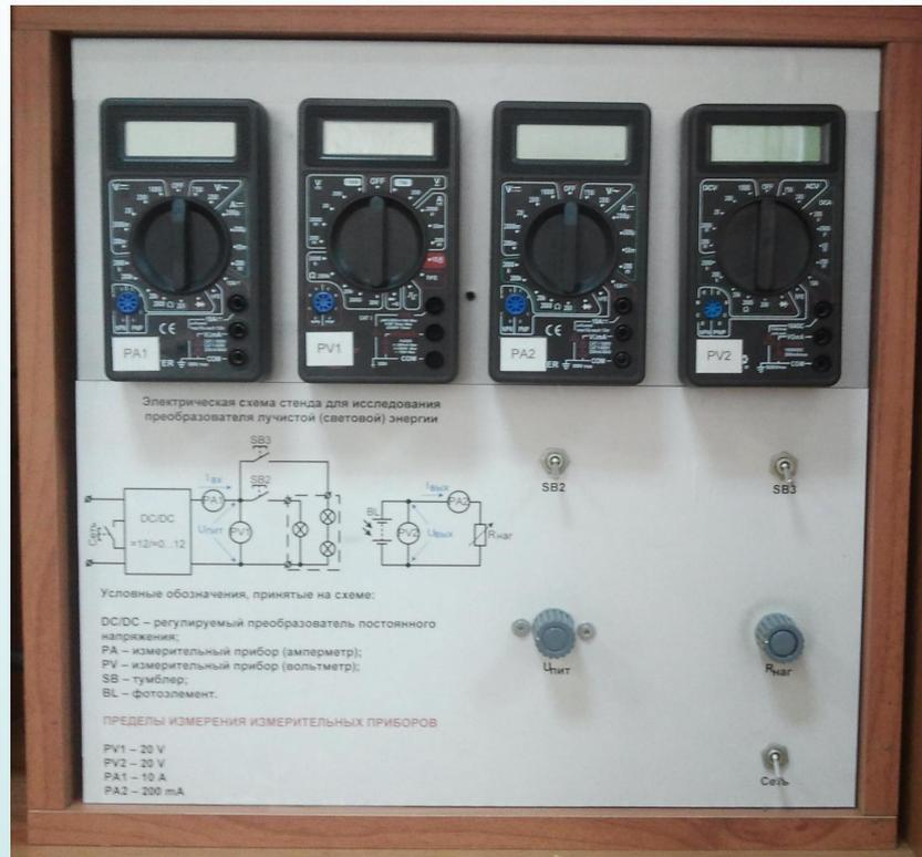
Рисунок 1.4 – Внешний вид лабораторного стенда
