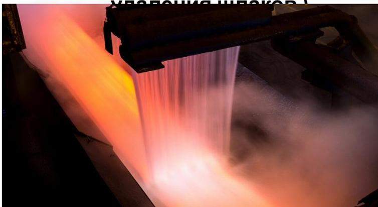
В цехах горячего проката вода используется для охлаждения элементов нагревательной печи (балок, водяных затворов, задвижек, заслонок)
