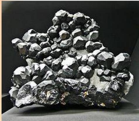
Магнетит (*от античного города Магнесия в Малой Азии*)  $\text{Fe}_3\text{O}_4$  – природный минерал с сильными магнитными свойствами (притягивает и намагничивает железные предметы)
