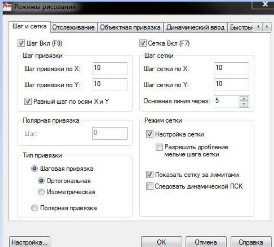
Под зоной командных строк находится строка с прямоугольными кнопками режимов. Режим считается включенным, если включена (нажата) соответствующая ему кнопка. Настройка режимов может быть осуществлена с помощью пункта *Режимы рисования* падающего меню *Сервис*, а также с помощью пункта *Настройка* контекстного меню, вызываемого с помощью щелчка правой кнопкой мыши, если поставить ее указатель на одну из кнопок режимов.
