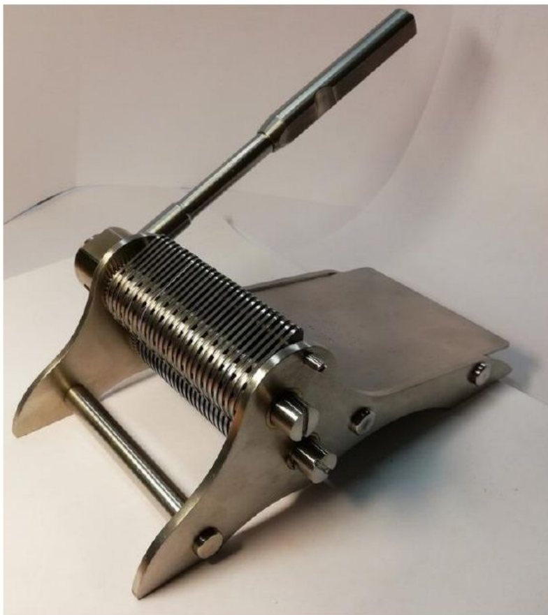
Перфоратор ПАДТ-1,0 на двух валах. Патент № 2594446. Автор В. А. Мензул. Шаг перфорации 1:4.
