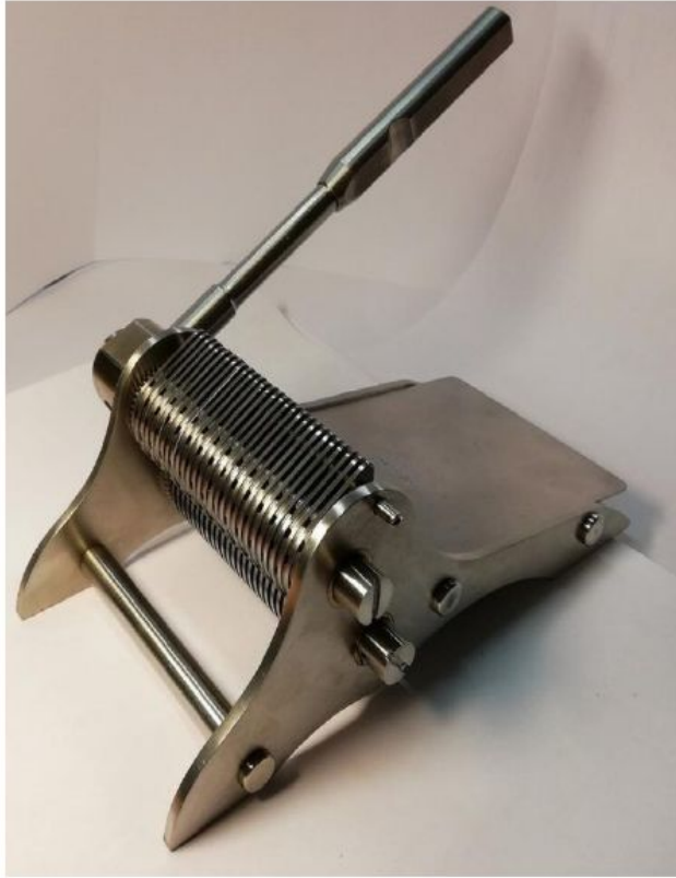
Перфоратор ПАДТ -1,0 на двух валах.
