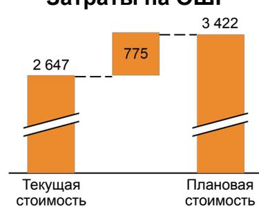
Рост стоимости на 775 руб./м3 связан с увеличением количества техники используемой при производстве работ (добавлены: +1 ед. ПДМ, +1 ед. самосвал, +1 ед. торкрет установки)
