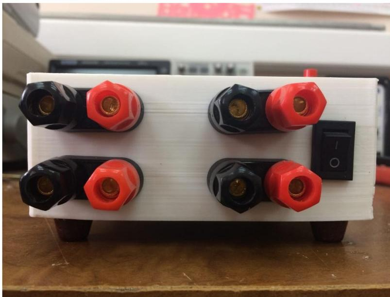
Мы подключили к преобразователю 16 вольт и получили четыре стабилизированных напряжения: 5В, 3В, 4В, 9В, которыми можно управлять отдельно. Корпус был изготовлен на 3D принтере.
