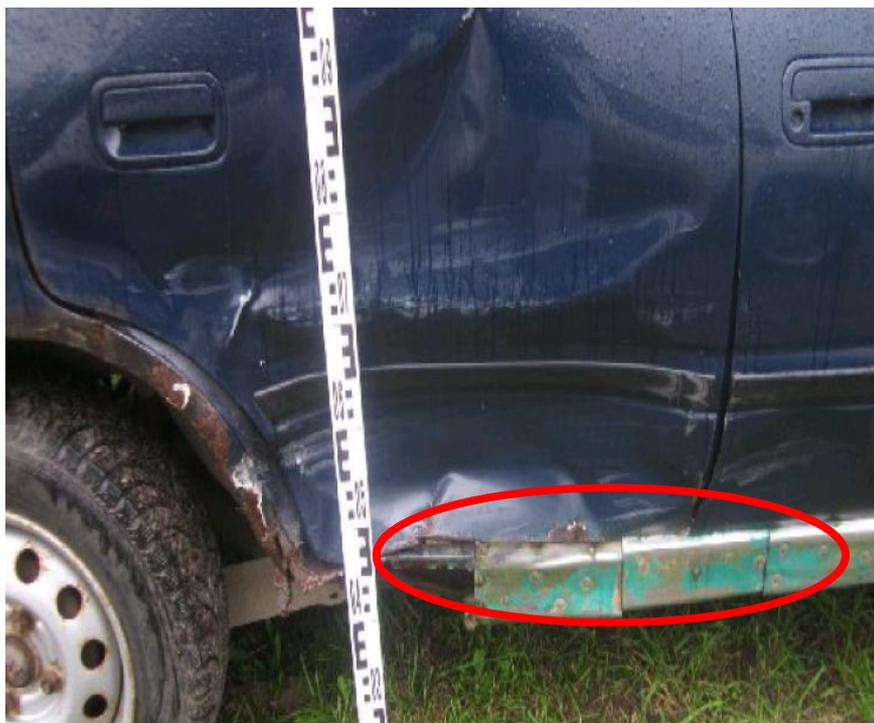
На поврежденном элементе в зоне повреждения имеются следы несквозной коррозии
