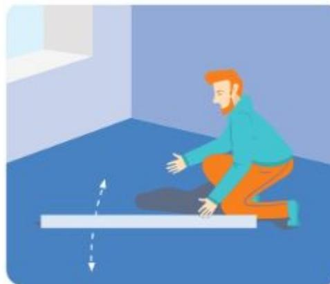
Проверка неровностей пола с помощью линейки-уровня.
