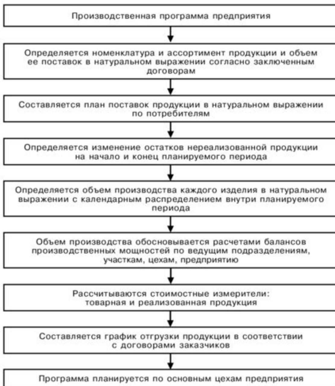
Рис. 9.7. Последовательность разработки производственной программы
