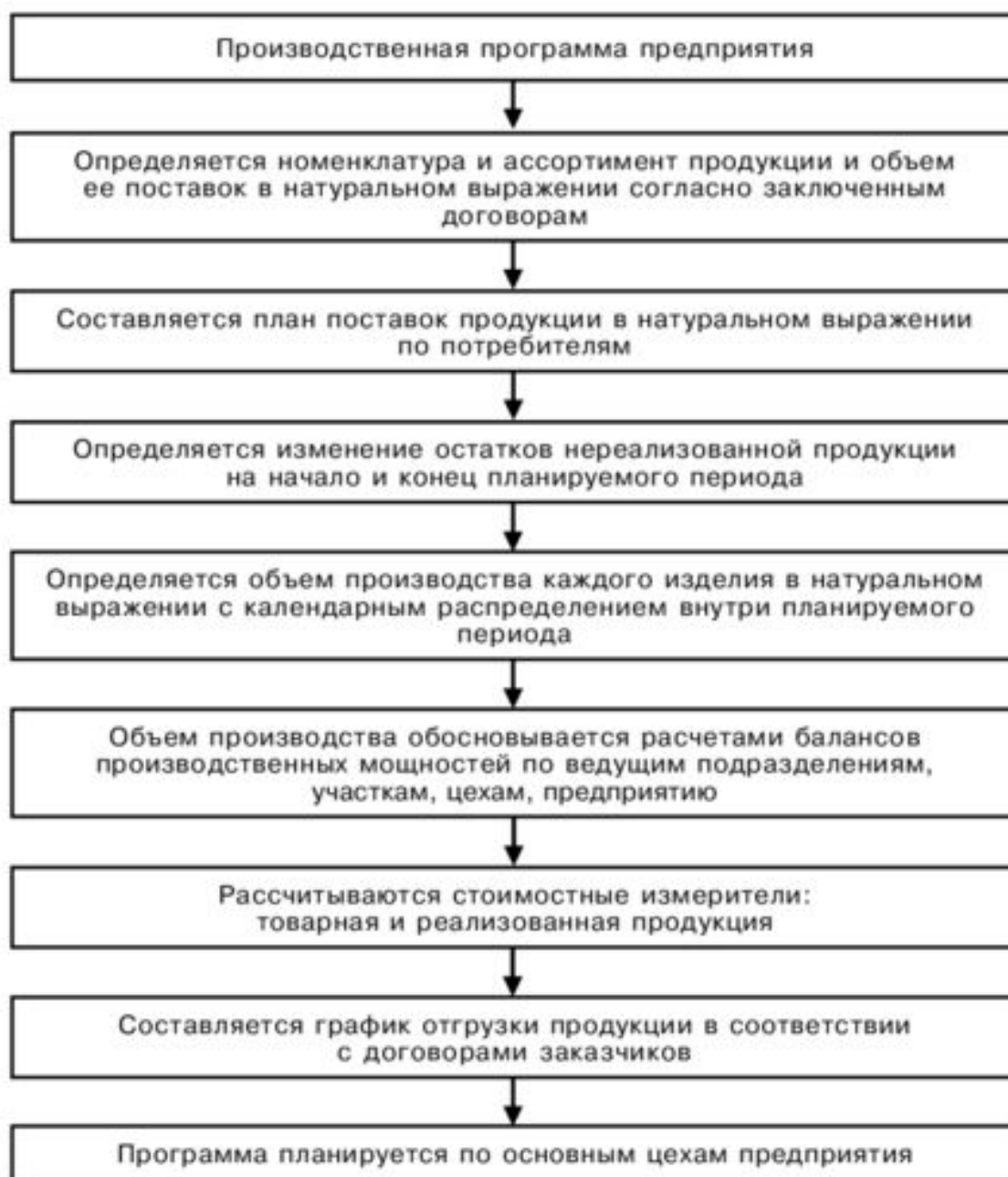
Рис. 9.7. Последовательность разработки производственной программы
