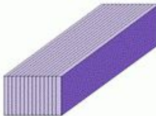
Шихтованный магнитопровод из листовой стали
