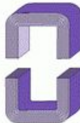
Шихтованный магнитопровод из ленточной стали
