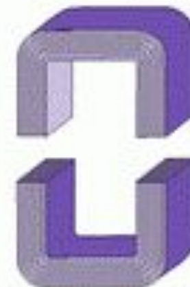
Шихтованный магнитопровод из ленточной стали
