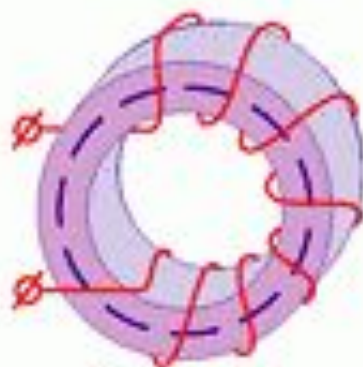
Катушка с тороидальным сердечником
