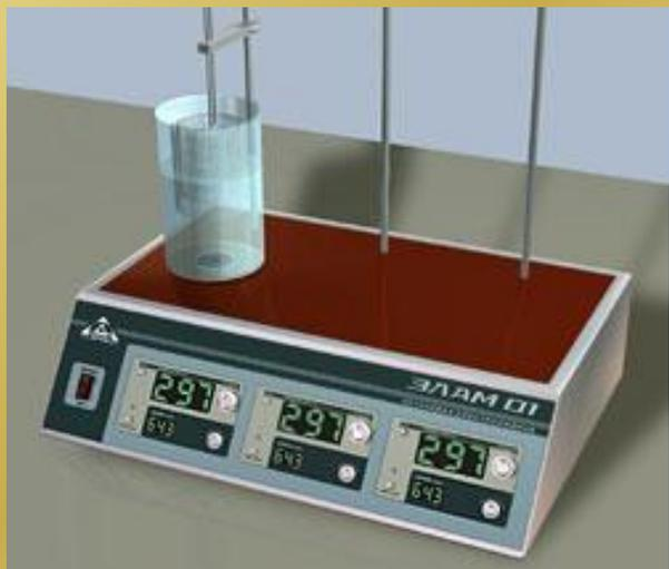
Лабораторная электролизная установка для анализа металлов «ЭЛАМ».
