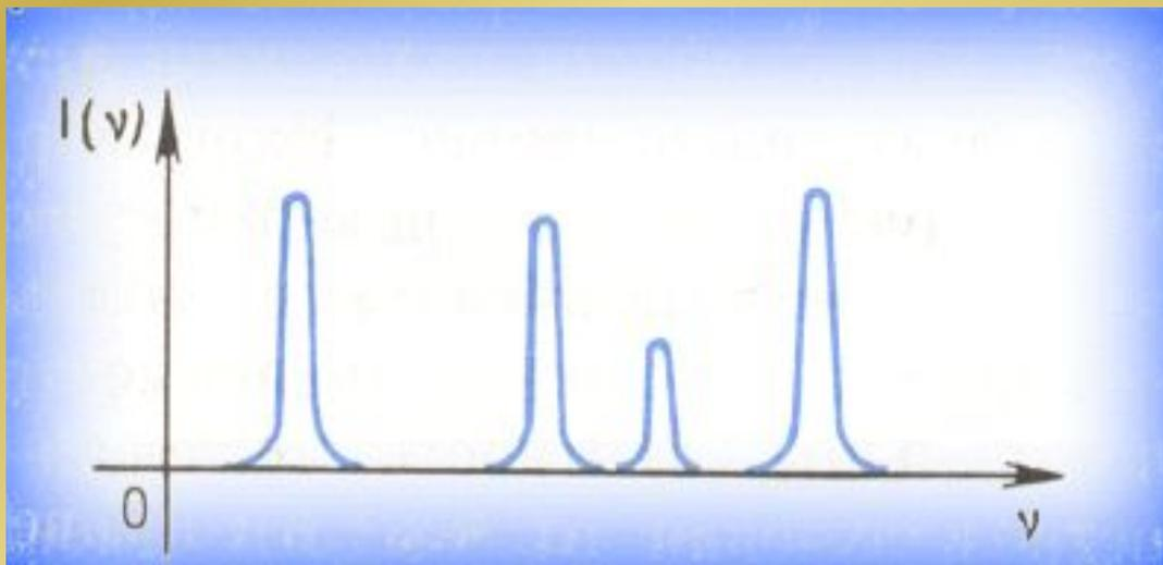
Примерное распределение спектральной плотности интенсивности излучения в линейчатом спектре.
