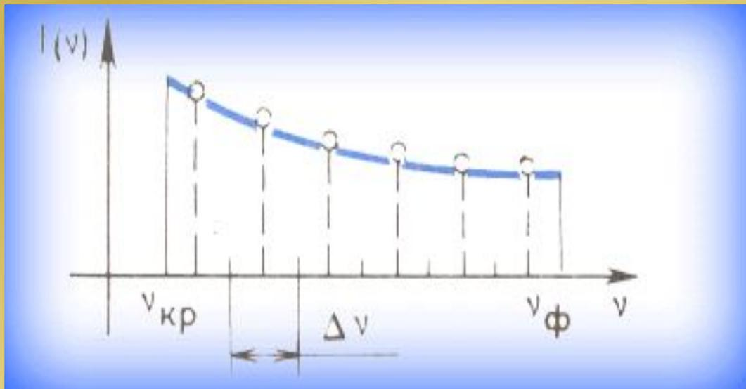
Кривая зависимости спектральной плотности интенсивности излучения от частоты в видимой части спектра электрической дуги.
