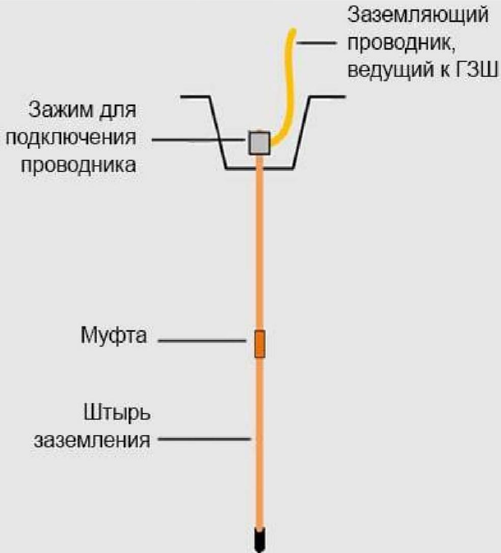
**Модульное заземление** – такой тип заземляющего устройства, при котором можно варьировать общую длину и количество точек установки в грунт вертикальных заземлителей.
