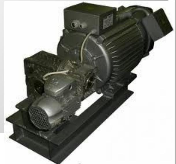
Ротор ИР заторможен посредством червячной передачи, которая не только удерживает его в заданном положении, но и позволяет плавно поворачивать его относительно статора. Обмотки статора и ротора в ИР имеют автотрансформаторную связь (рис. 1) поэтому ИР иногда называют поворотным автотрансформатором
