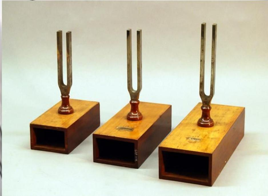
Ящики, на которых установлены камертоны, способствуют усилению звука и наиболее полной передаче энергии от одного камертона к другому. Усиление звука происходит за счёт колебаний самого ящика и особенно столба воздуха в нём. Звуковые волны, образованные камертоном А, дойдя до камертона В, возбуждают в нём вынужденные колебания. Поскольку собственные частоты колебаний камертонов одинаковы, то имеет место резонанс: камертон В колеблется с наибольшей возможной амплитудой и издаёт звук.
