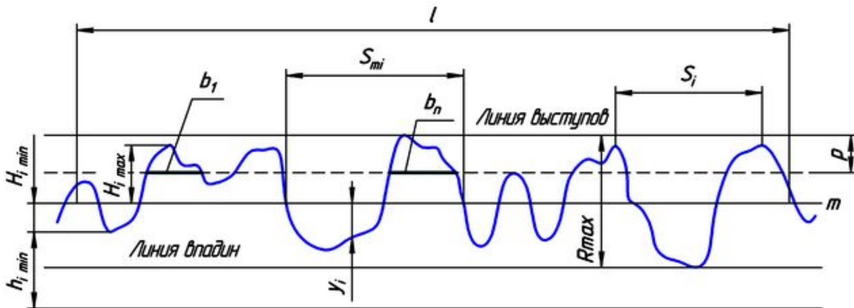
$b_1, b_i, b_n$  –длины отрезков в пределах базовой длины;
