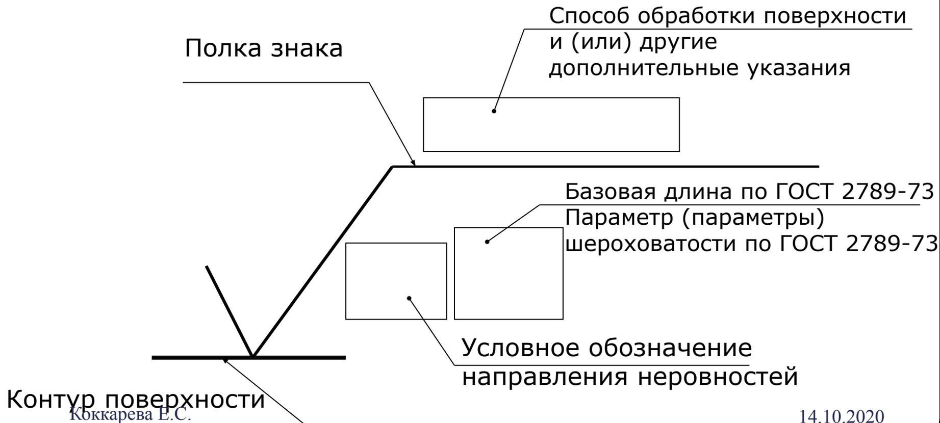
Рисунок 5- Обозначение шероховатости
