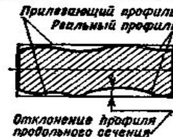
Рис. 9. Нецилиндричность — отклонение профиля продольного сечения
