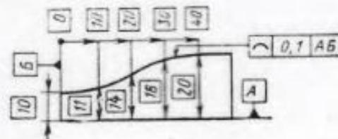
Допуск формы заданной поверхности — наибольшее отклонение точек реальной поверхности от номинальной поверхности, определяемое по нормали к номинальной поверхности
