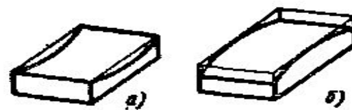
Рис. 6. Виды нелоскостности и непрямолинейности:
