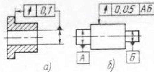
Допуск полного радиального (торцового) биения — разность наибольшего и наименьшего расстояний от всех точек реальной поверхности до базовой оси вращения (до плоскости, перпендикулярной базовой оси)
