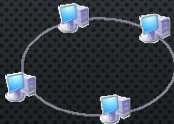
Если компьютер получает данные, предназначенные для другого компьютера – он передает их дальше по кольцу, в ином случае они дальше не передаются.
