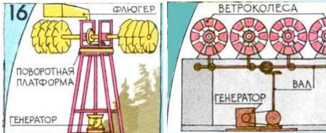
Принцип действия ветряных электростанций прост: ветер крутит лопасти ветряка, приводя в движение вал электрогенератора. Генератор в свою очередь вырабатывает электрическую энергию.
