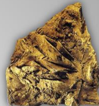
Лимонит (бурый железняк) \text{Fe}_2\text{O}_3 \cdot n\text{H}_2\text{O}
