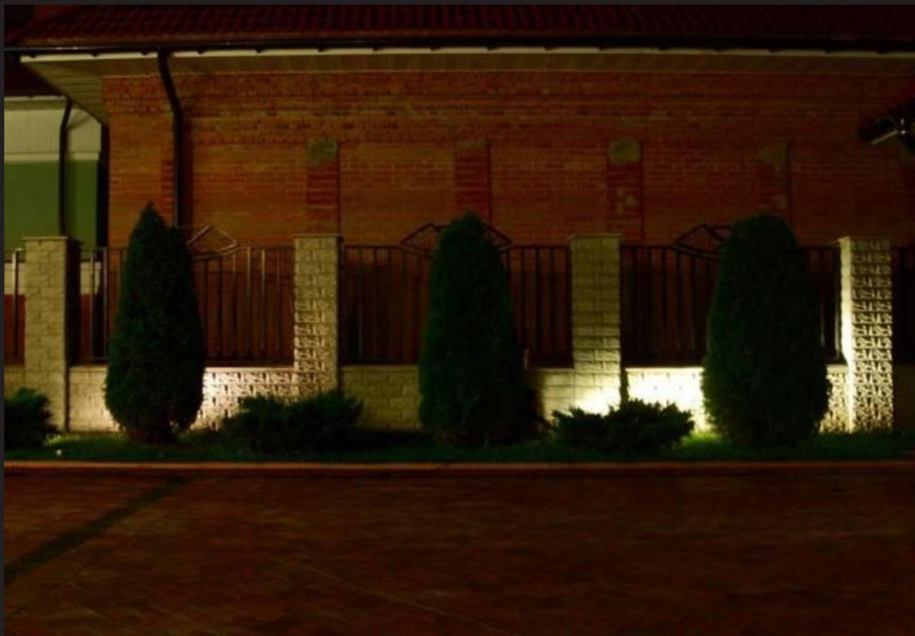
*Светильники встроенные в грунт устанавливаются с внешней стороны ограждения позади высаженных групп растений. За счет этого достигается эффект контрсвета – силуэты растений отчетливо видны на фоне освещенной плоскости ограждения*
