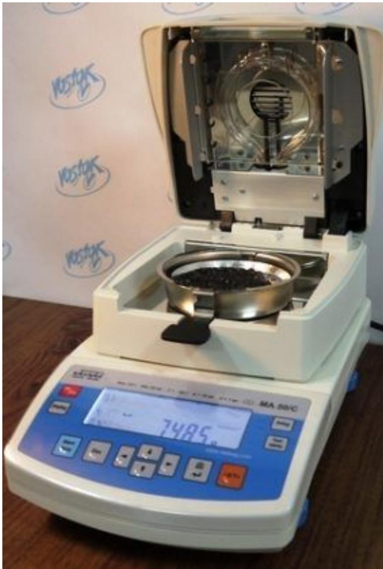
Весоизмерительное оборудование помогает правильно определить закупочную цену на зерно. К примеру, ошибка в показателе влажности всего в 1% приводит к необходимости проведения дополнительных сушки, проветривания, перемешивания сыпучего продукта. Точные данные избавят предприятие от лишних операций и затрат.
