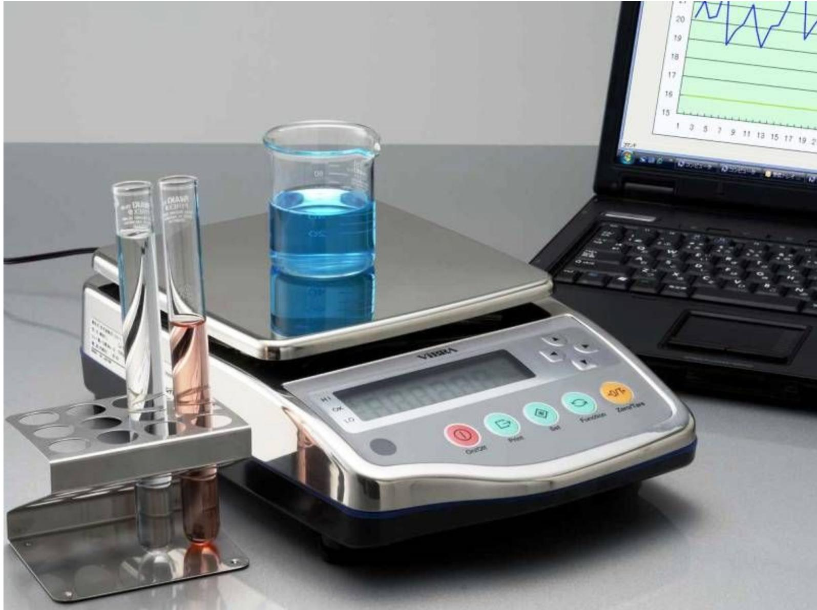
**Весы-влажмеры.** Приборы востребованы в различных ситуациях. Перед помещением зерна в сушильный шкаф, устанавливают один из алгоритмов метода термогравиметрической сушки, предусмотренных ГОСТ. Для правильного выбора алгоритма необходимо знать исходную влажность зерна. В лабораториях постоянные проверки влажности проводят периодически. Это вызвано тем, что избыточная влажность в течение долгого времени снижает сроки сохранности зерна; резко уменьшаются его технические характеристики.
