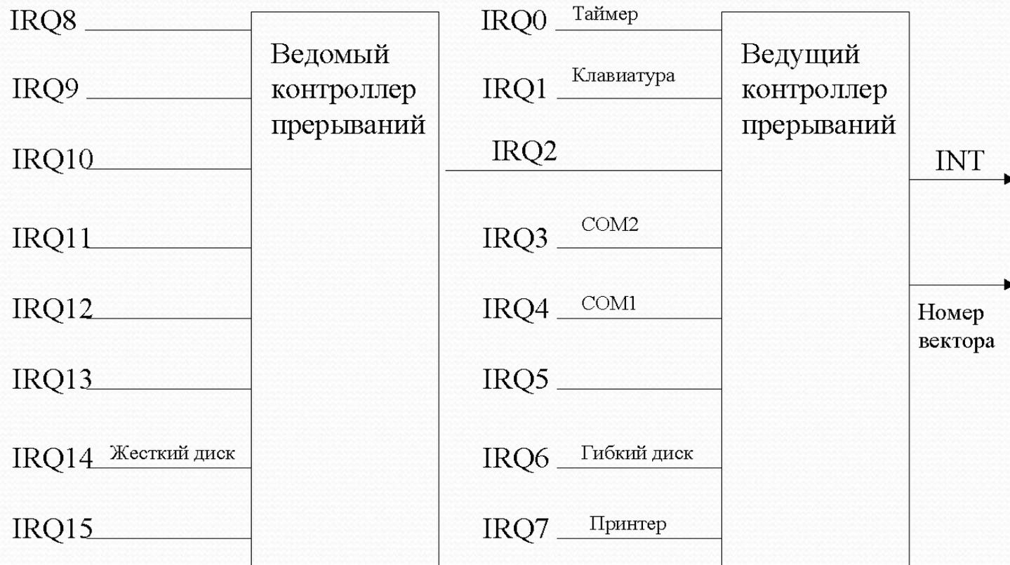
Номера базовых векторов заносятся в контроллеры автоматически в процессе начальной загрузки компьютера. Для ведущего контроллера базовый вектор всегда равен 8, для ведомого – 70H. Таким образом, номера векторов, закрепленных за аппаратными прерываниями, лежат в диапазонах 08h...0Fh и 70h...77h. Очевидно, что номера векторов аппаратных прерываний однозначно связаны с номерами линий, или уровнями IRQ, а через них – с конкретными устройствами компьютера.
