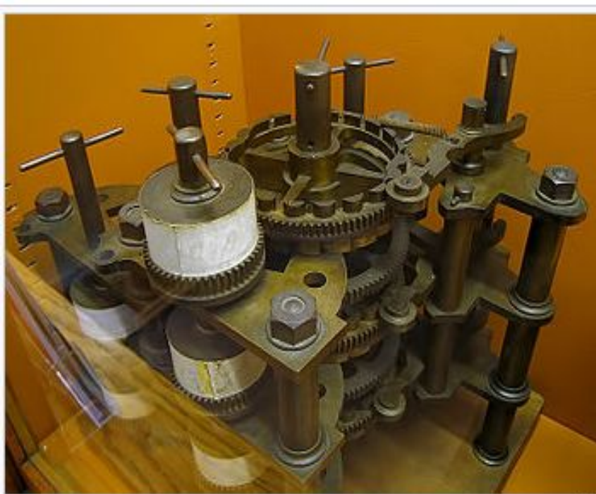
Часть разностной машины Чарльза Бэббиджа, собранная после смерти учёного его сыном из деталей, найденных в лаборатории отца.
