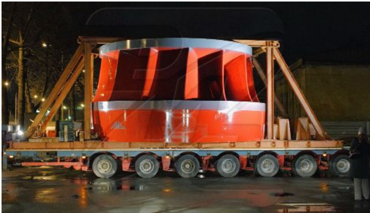
Транспортировка рабочего колеса гидротурбины
