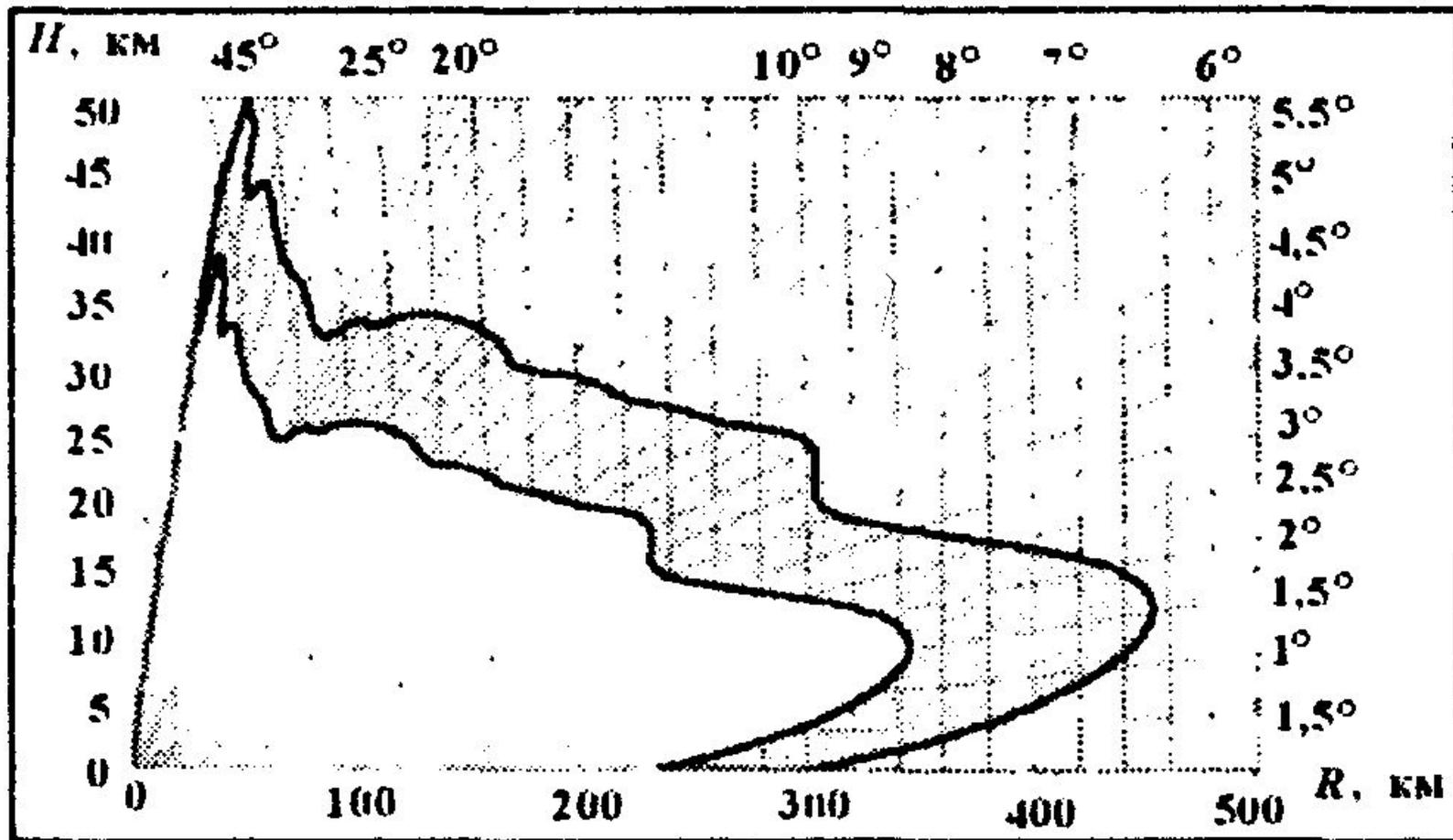
Пример зоны обнаружения в вертикальной плоскости для радиолокатора «Утес-Т» (светлая зона – работа на одной частоте, темная зона – на двух частотах)
