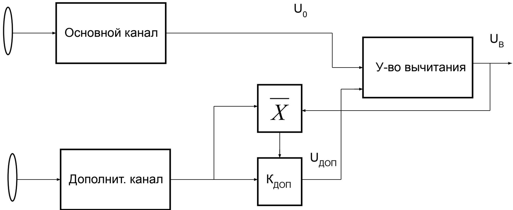
Сигнал присутствует в основном канале, а активная помеха и в основном и дополнительном каналах. Корреляционная ОС обеспечивает эквивалентность АП в каналах, что необходимо для ее компенсации. Определим коэффициент передачи по дополнительному каналу (и цепи ОС).
