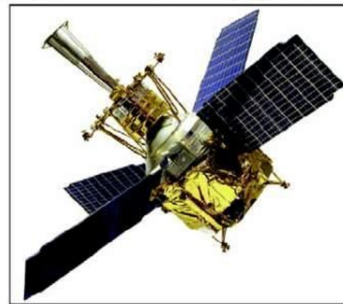
Спутник, запущенный в рамках проекта GPB. Все экспериментальное оборудование заключено в большой контейнер с жидким гелием.
