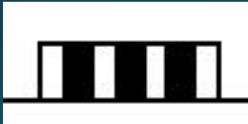
**2.3** – обозначает круглые тумбы, установленные на разделительных полосах или островках безопасности
