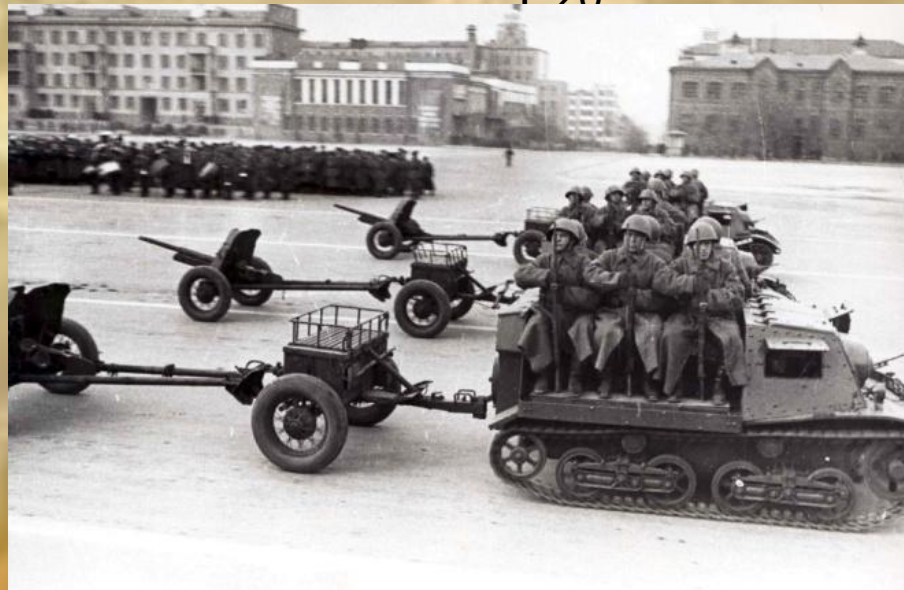
Бронированные тягачи Комсомолец Т-20
