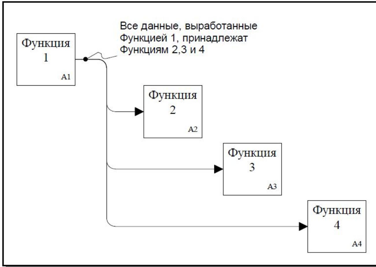
Чтобы стрелки и их сегменты правильно описывали связи между блоками - источниками и блоками - потребителями, используется аппарат меток. Метки связываются с сегментами посредством тильд.
