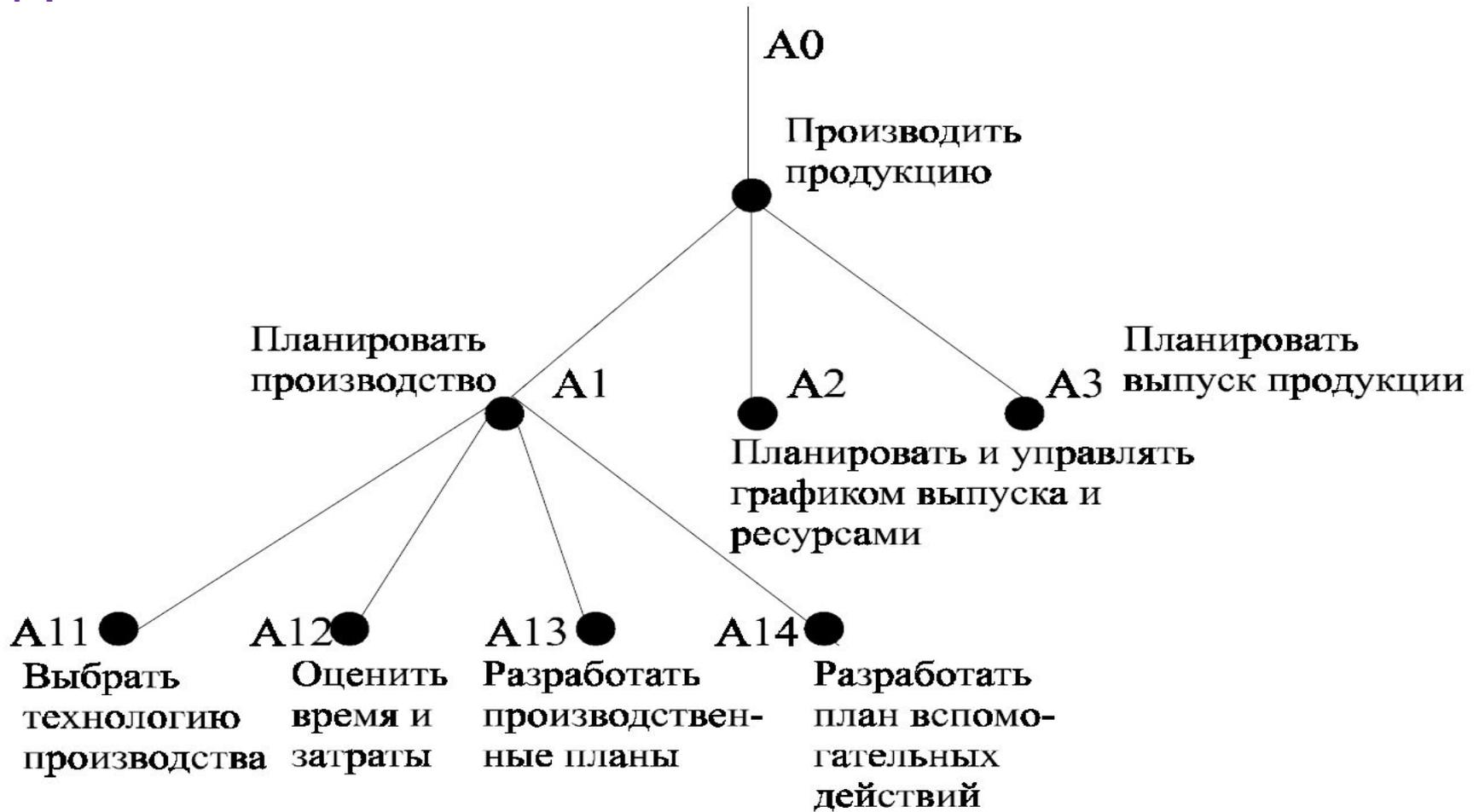
Разработанная модель IDEF0 со всеми уровнями структурной декомпозицией может быть представлена на единственной диаграмме в виде дерева узлов, дополняющего перечень узлов.
