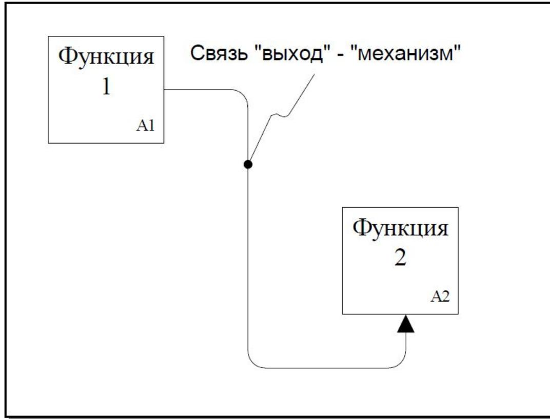
**Связи «выход – механизм»** отражают ситуацию, при которой выход одной функции становится средством достижения цели для другой.
