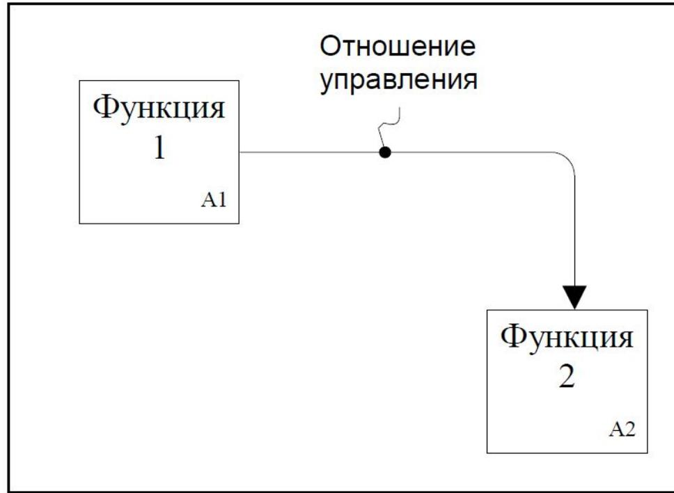
**Отношение управления** возникает тогда, когда выход одного блока служит управляющим воздействием на блок с меньшим доминированием
