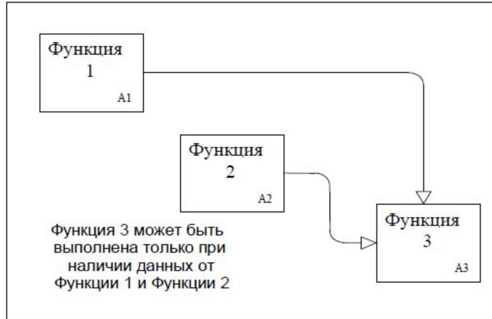
Входные и управляющие стрелки блока, соединяющие его с другими блоками или с внешней средой, по сути описывают условия, которые должны быть выполнены для того, чтобы реализовалась функция, записанная в качестве имени блока
