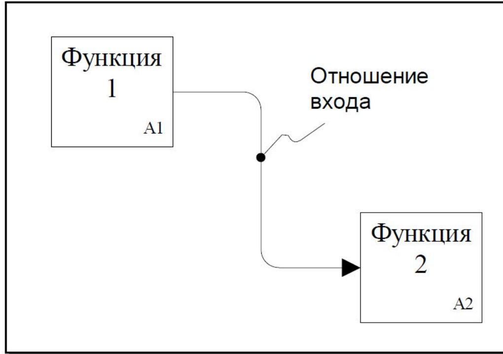
**Отношение выход – вход** возникает при соединении выхода одного блока с входом другого блока с меньшим доминированием
