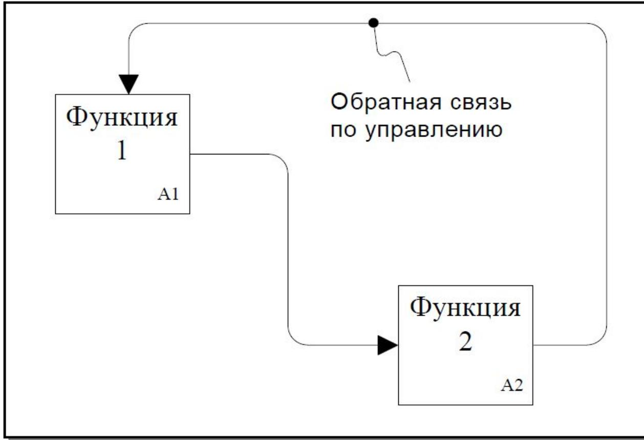
**Обратная связь по управлению** возникает тогда, когда выход некоторого блока создает управляющее воздействие на блок с большим доминированием
