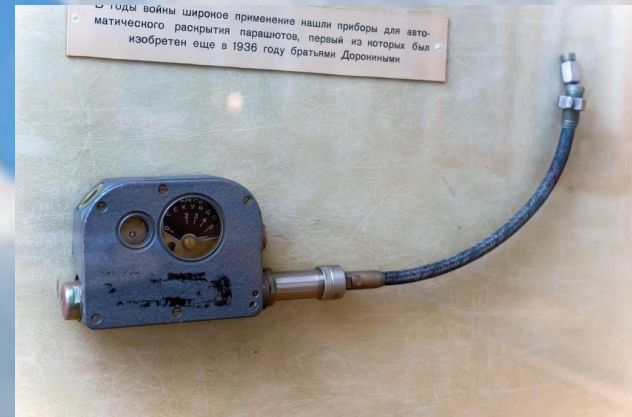
прибор для автоматического раскрытия парашюта. (ППД-1)
