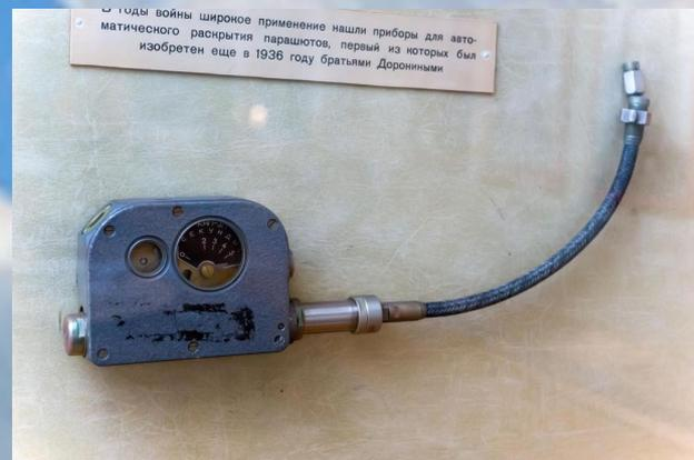
прибор для автоматического раскрытия парашюта. (ППД-1)
