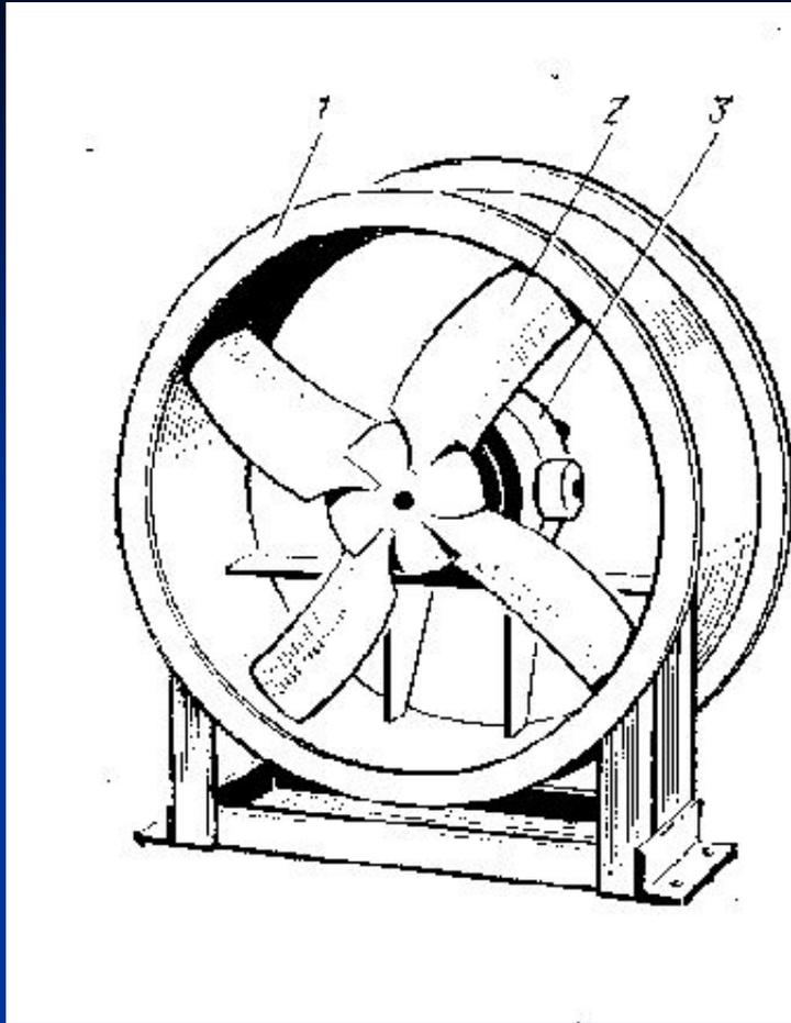
Рис. 15 Осевой вентилятор
