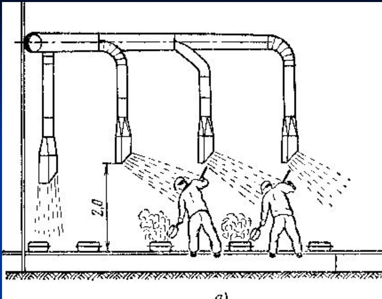
Рис. 17 Местная приточная вентиляция - воздушное душирование
