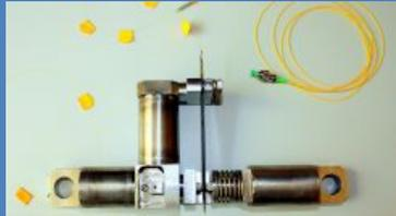
Волоконно-оптический датчик механической деформации продольного растяжения/сжатия
