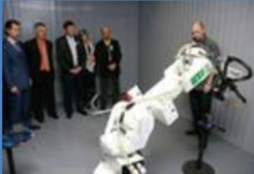
Уникальный роботизированный комплекс на основе волоконных лазеров мощностью  $0,4$  кВт,  $2$  кВт  $5$ кВт, способный производить 3-х мерную резку, сварку и закалку разнообразных деталей сложного профиля.
