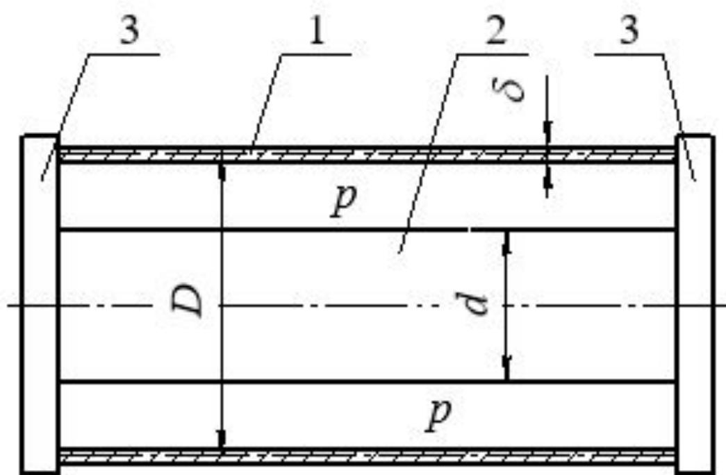
1 – тонкостенная медная трубка;
