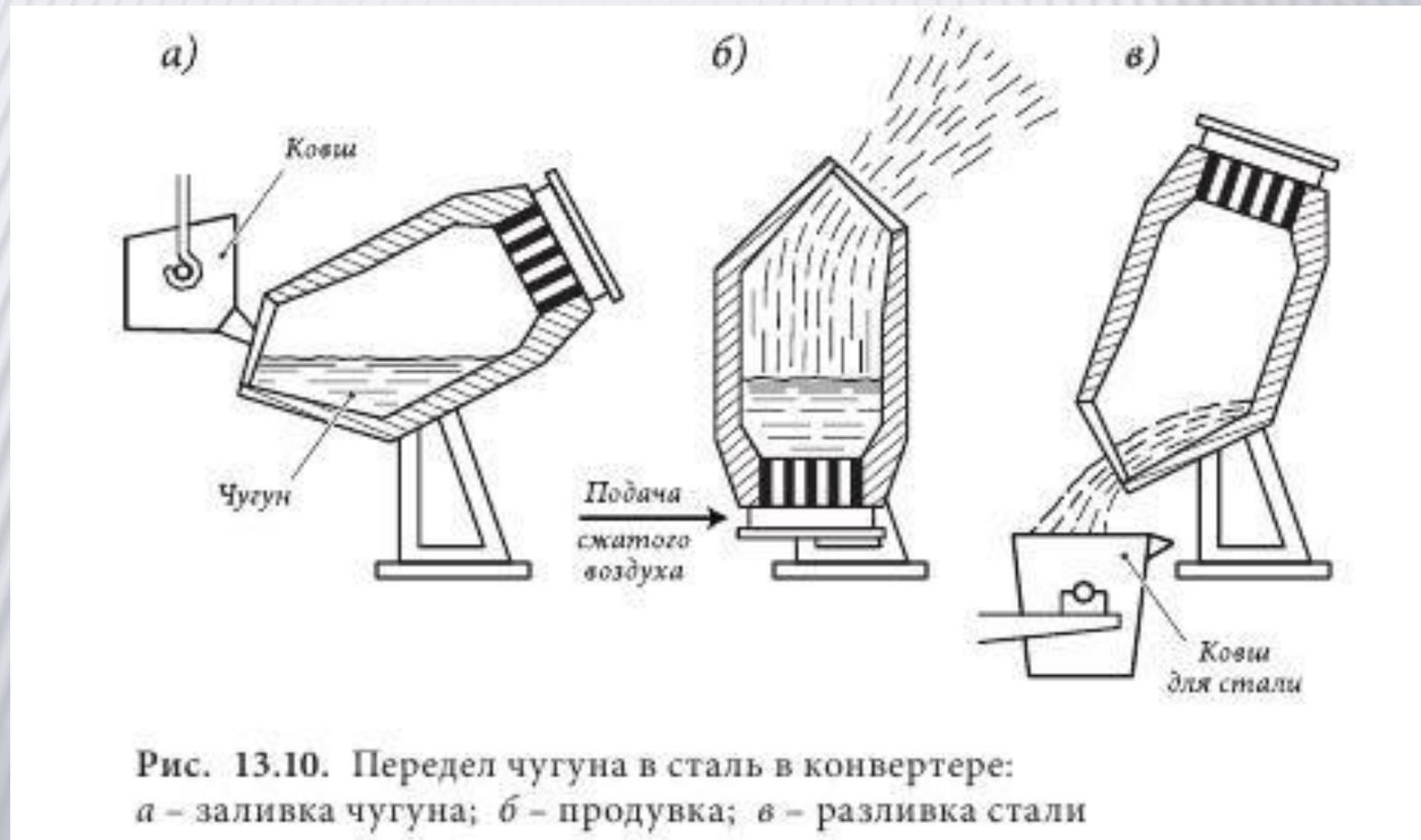
Кислород, находящийся в воздухе, вступает в реакцию с углеродом, кремнием, марганцем и другими примесями в чугуне и окисляет их. Процесс выплавки осуществляется только за счет теплоты химических реакций окисления примесей с учетом физической теплоты жидкого чугуна.
