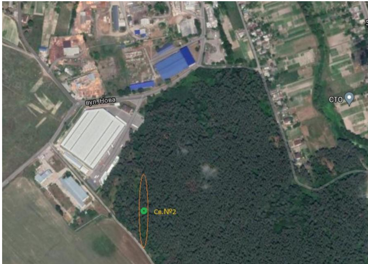
Схема II поясу зони санітарної охорони в умовах ухилу потоку відносно водозабірної свердловини №2, канівсько-бучацький водоносний горизонт
