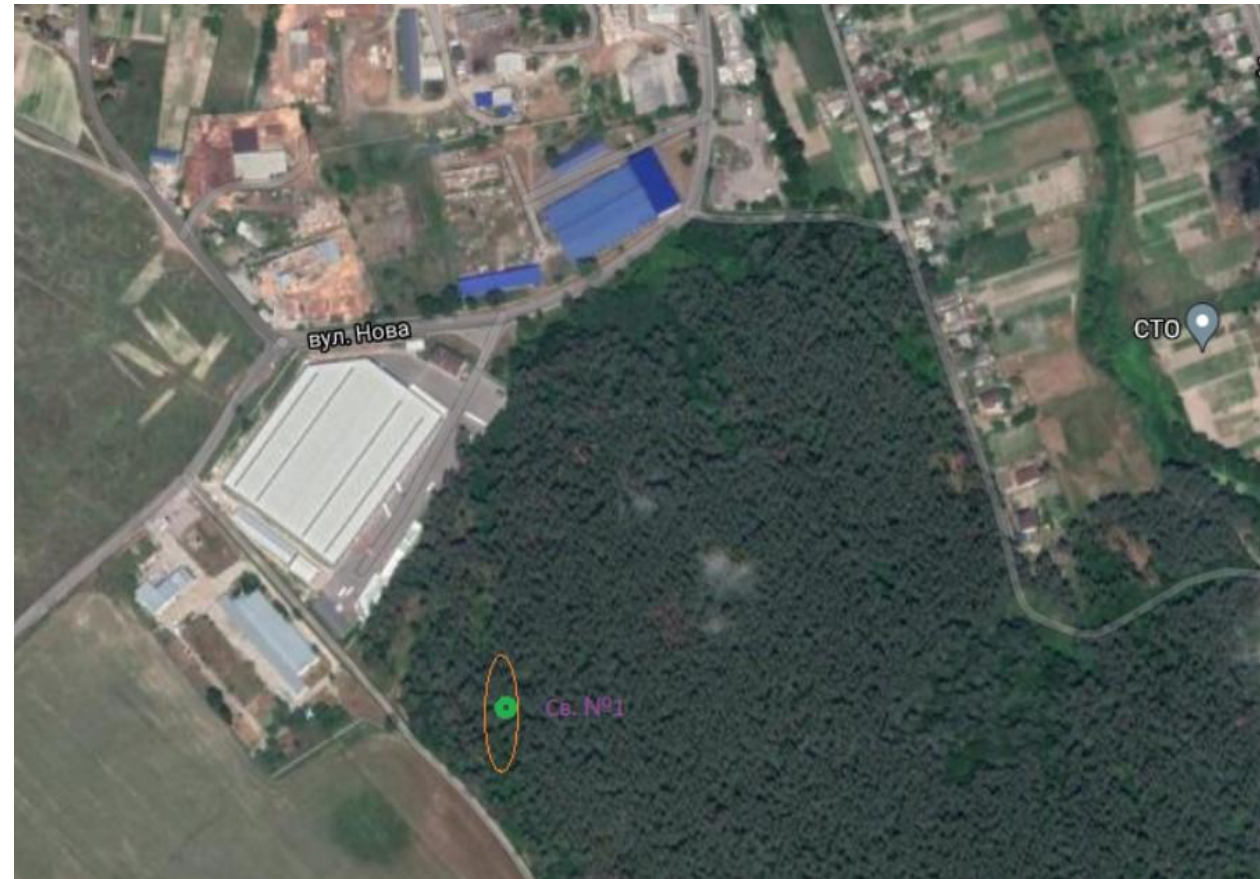
Схема II поясу зони санітарної охорони в умовах ухилу потоку відносно водозабірної свердловини №1, сеномакеловейський водоносний горизонт
