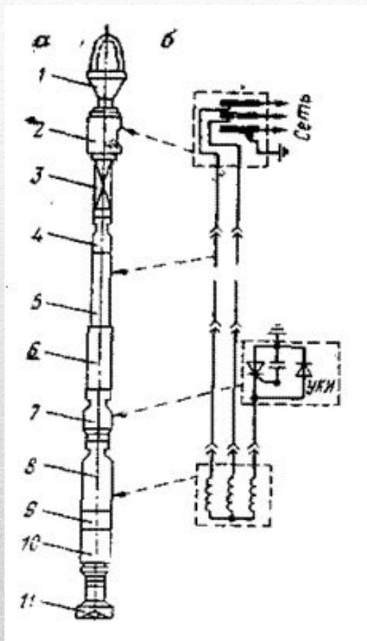
На рис. А показана компоновка бурильной колонны с электробуром, состоящая из асинхронного трехфазного электродвигателя 8 переменного тока с короткозамкнутым ротором, редуктора-вставки 9 для снижения частоты вращения, шпинделя 10 для восприятия осевых нагрузок, к которому присоединяется долото 11. Двигатель электробура соединен с устройством для контроля его изоляции (УКИ) 7.
