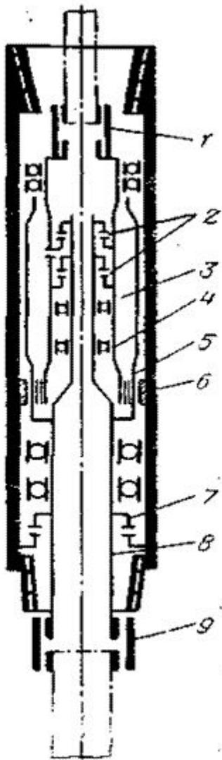
Редуктор-вставка представляет собой механизм, размещенный в цилиндрическом корпусе 6, состоящий из планетарного цилиндрического зубчатого редуктора, находящегося в верхней части, масляного лубрикатора 3, размещенного ниже редуктора и служащего для компенсации утечек смазки, сальниковых устройств 2 и 7 в верхней и нижней частях.
