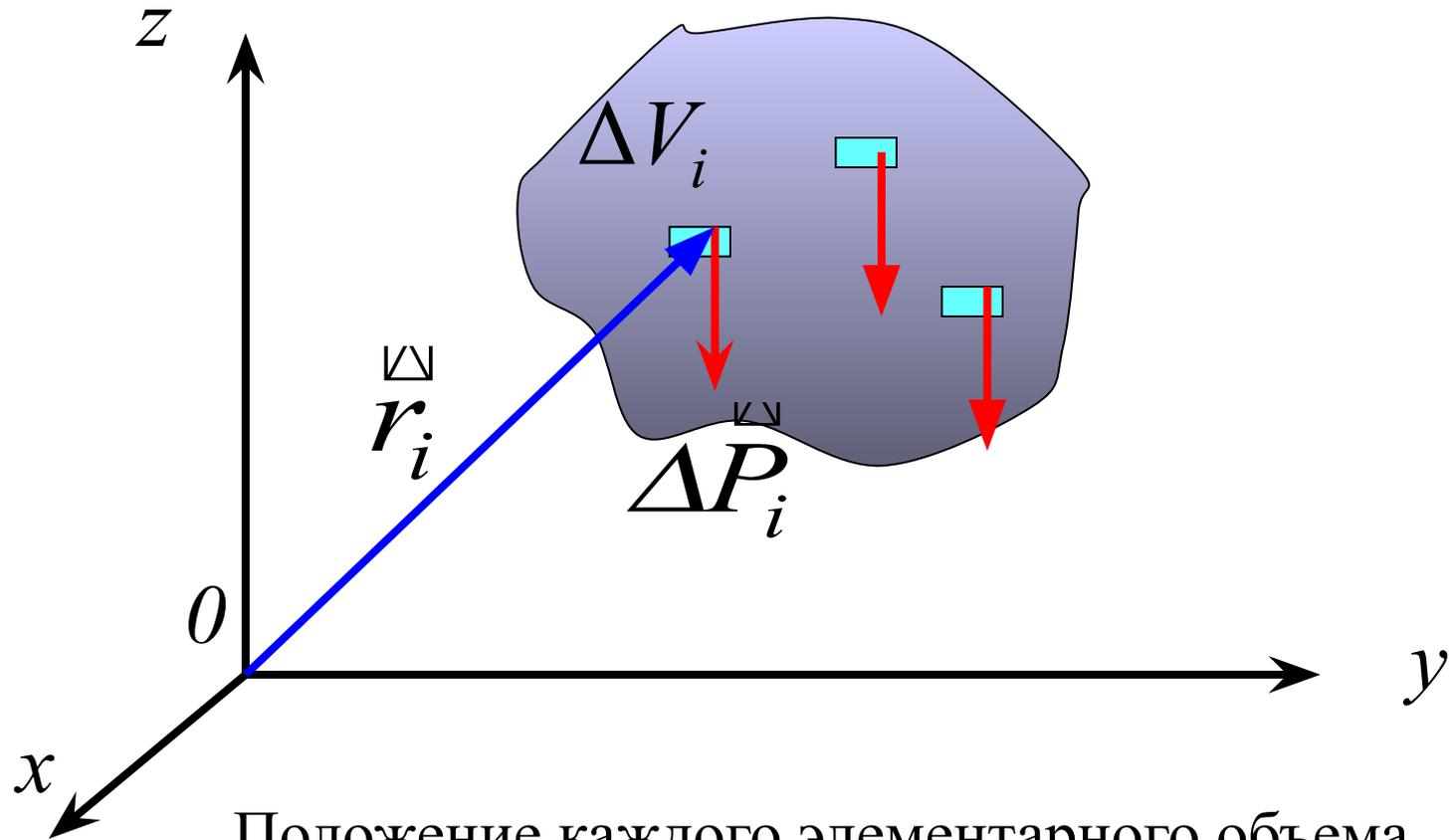
Положение каждого элементарного объема характеризуется радиус-вектором  $\vec{r}_i$
