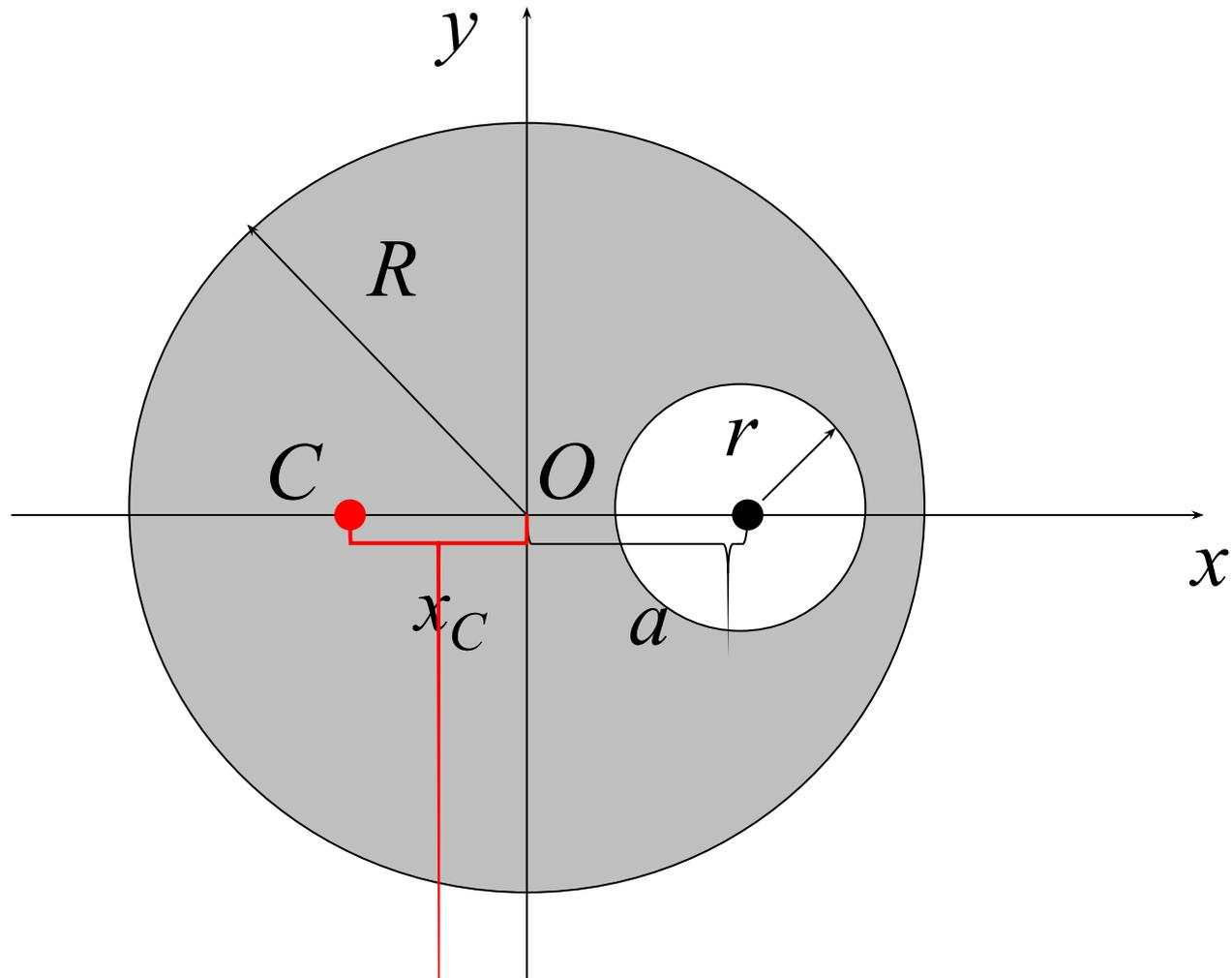
Значение  $x_C$  получилось отрицательным, следовательно центр масс пластины расположен левее точки  $O$ .
