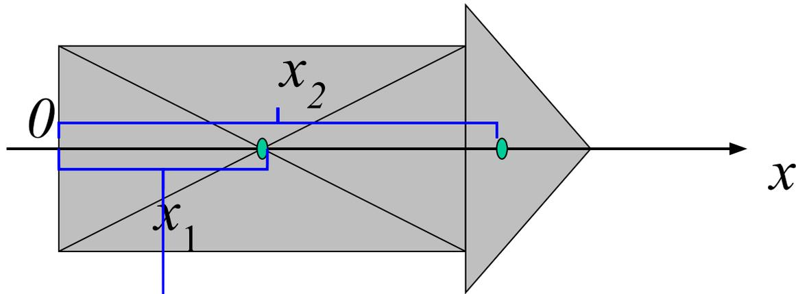
Разбиваем пластинку на простые геометрические фигуры. Из соображений симметрии определяем положение центра масс каждой фигуры. Координаты центров масс всех выделенных фигур определяются *в одной системе* отсчета.
