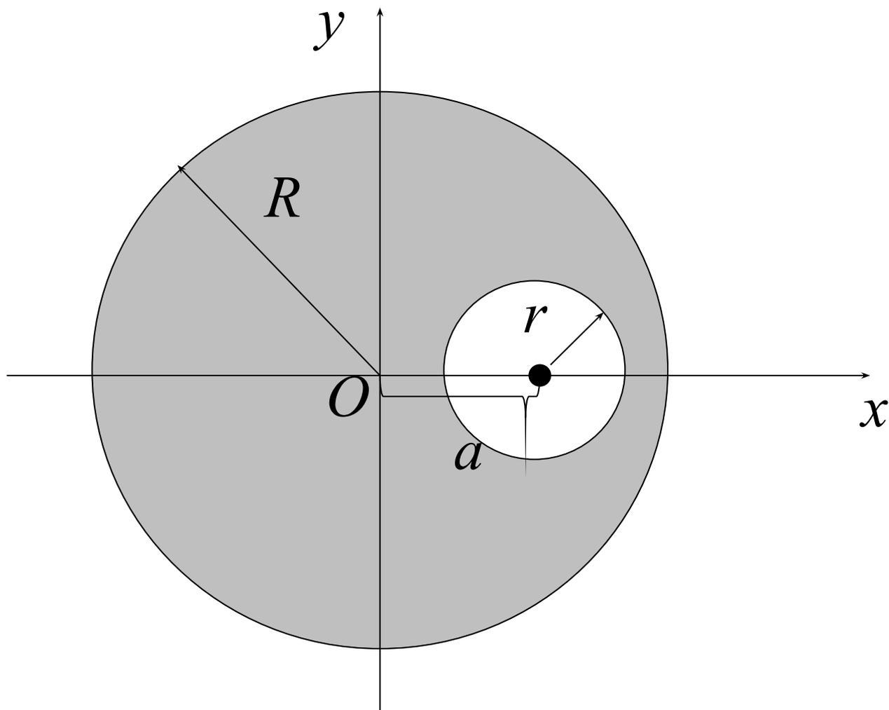
Требуется определить центр масс пластинки с вырезом.
